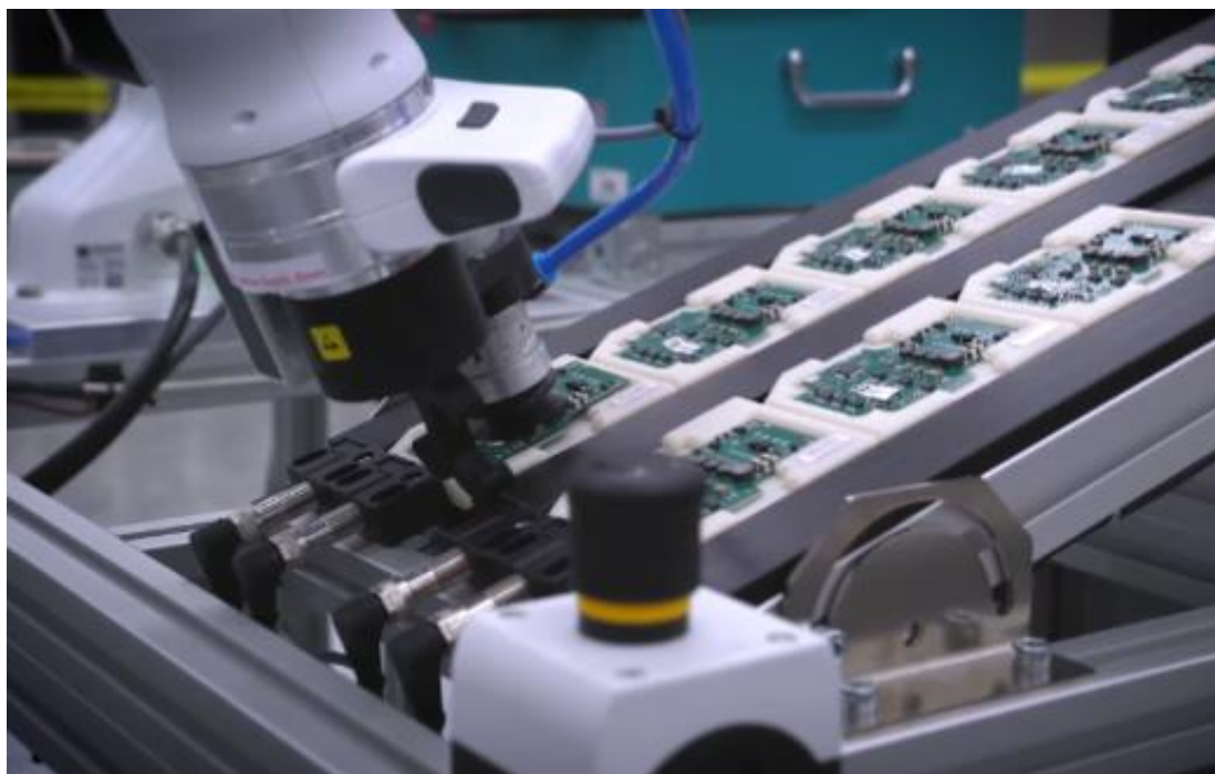
Slika 4. Kobot UR3 provodi kontrolu kvalitete [9]
