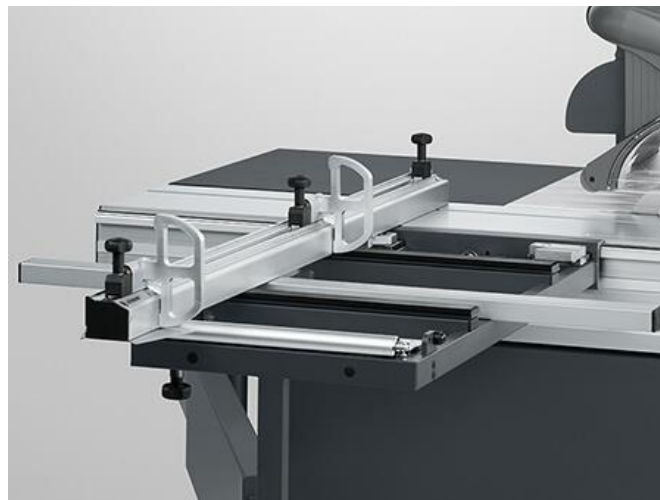
Slika 3. Poprečna vodilica s fiksnim kutem od 90° [8]
