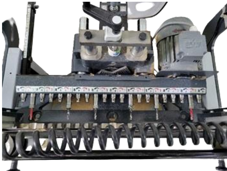
Slika 6. Jedinica s 21 vretenom
