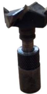
Slika 13. Svrldo za izradu okova \varnothing 35 \times 55 mm
