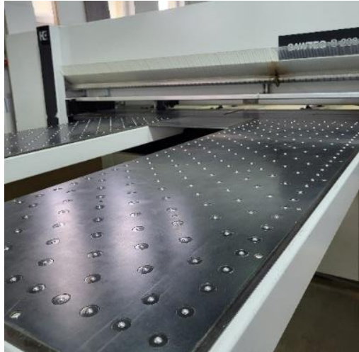
Slika 20. Mobilni stol sa zračnim jastukom
