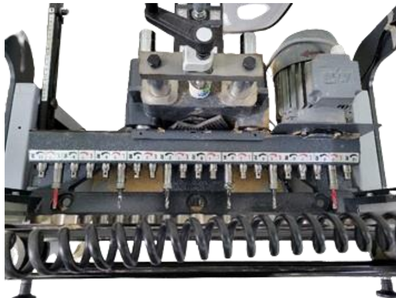
Slika 6. Jedinica s 21 vretenom
