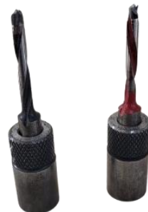
Slika 15. Svrđlo za izradu provrta za ručkicu \varnothing 8 \times 57,5 mm
