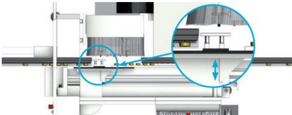
Slika 32. Automatsko podešavanje debljine radnog komada [12]
