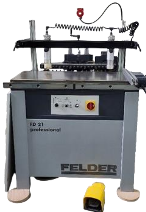
Slika 5. Viševretna bušilica Felder FD21 professional
