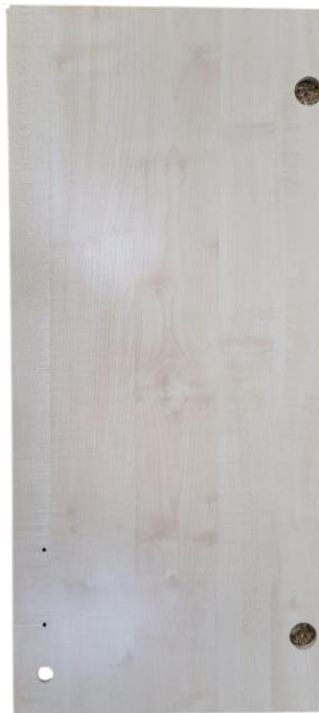
Slika 12. Vrata ormara s provrtima za ručkicu, bravicu i okove
