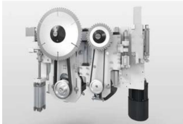
Slika 19. Sklop glavne pile i predrezača [10]
