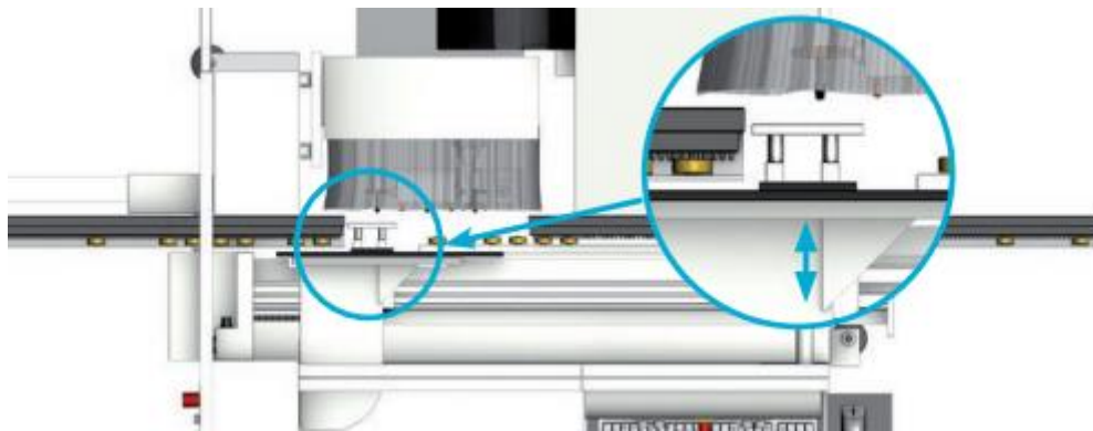
Slika 32. Automatsko podešavanje debljine radnog komada [12]
