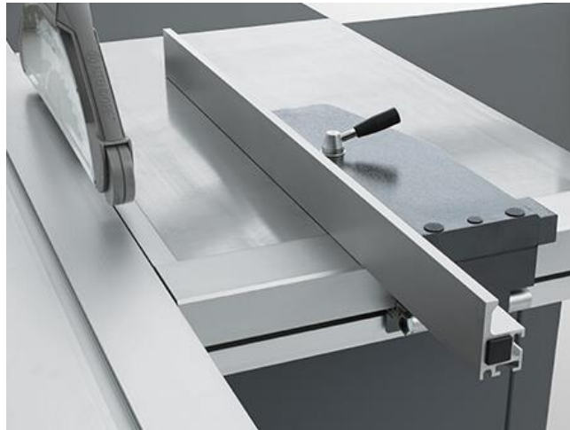
Slika 2. Vodilica s preciznim ručnim podešavanjem [8]
