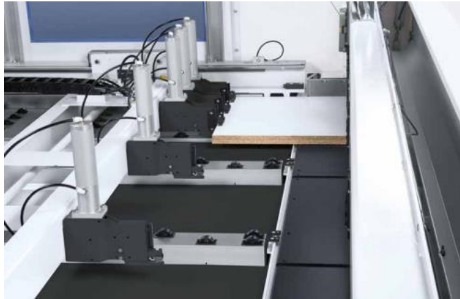
Slika 17. Programaska ograda za preciznost i dimenzijsku točnost [10]
