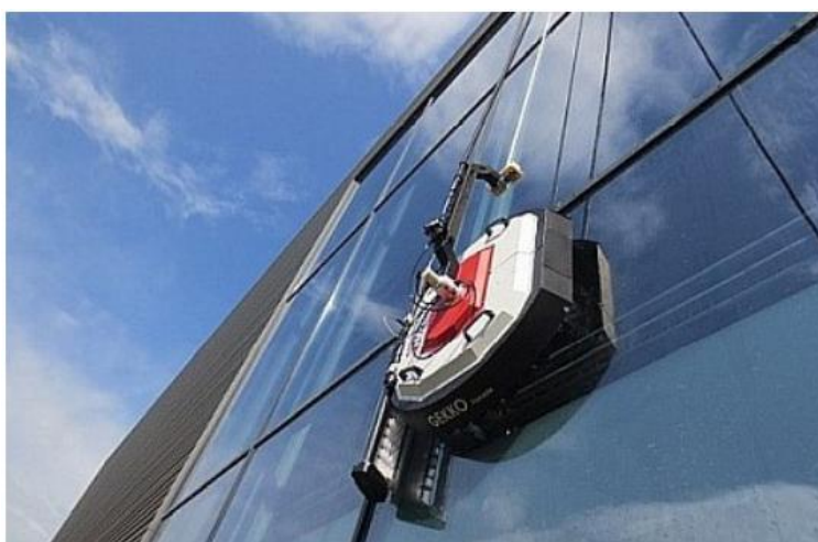
Slika 1.7 GEKKO robot za pranje prozora [9]
