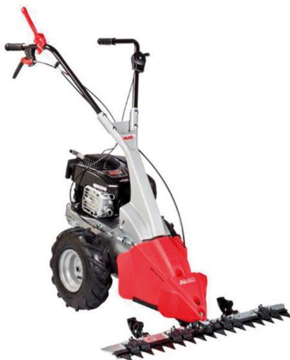
Slika 4. AL-KO strižna kosilica BM 875 III Briggs&Stratton
