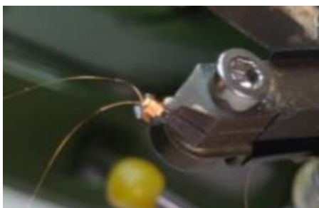
Slika 1 Prikaz namotane zavojnice veličine 1mm 3
