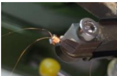
Slika 1 Prikaz namotane zavojnice veličine 1mm 3
