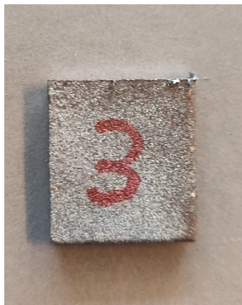
Uzorak 3 Vrijeme sušenja: 6 min Tlak plina: 10 mbar
