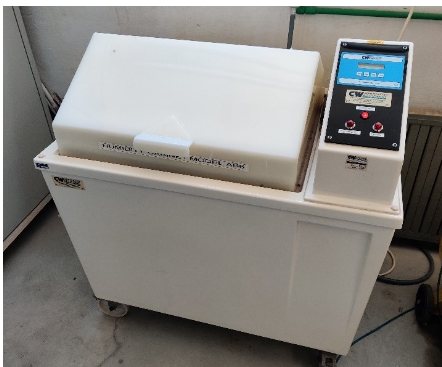
Slika 33. Vlažna komora C&W AB6
