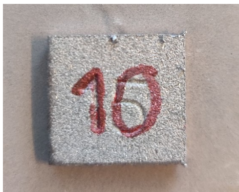
Uzorak 10 Vrijeme sušenja: 3 min Tlak plina: 20 mbar
