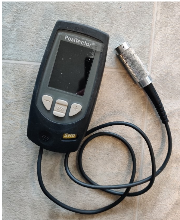
Slika 24. uređaj Positector s nastavkom SHD za mjerenje tvrdoće
