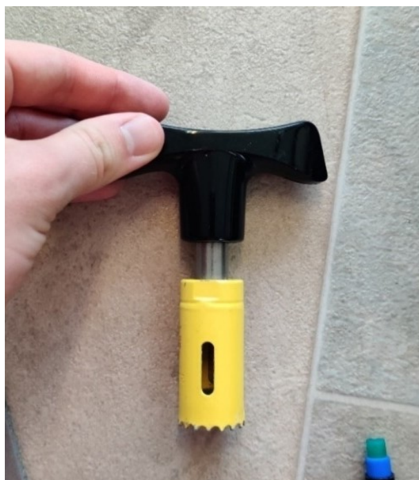
Slika 38. Alat za zarezivanje
