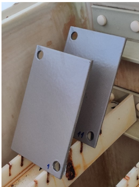
Slika 34. Uzorci prije ispitivanja u vlažnoj komori
