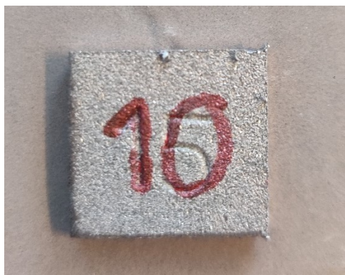
Uzorak 10 Vrijeme sušenja: 3 min Tlak plina: 20 mbar
