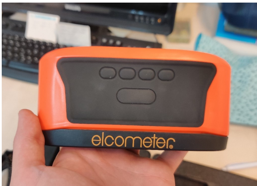
Slika 25. Elcometer 480 uređaj za mjerenje sjaja premaza
