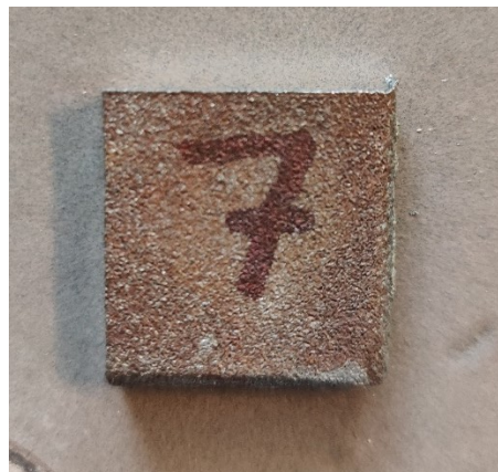
Uzorak 7 Vrijeme sušenja: 4 min Tlak plina: 15 mbar
