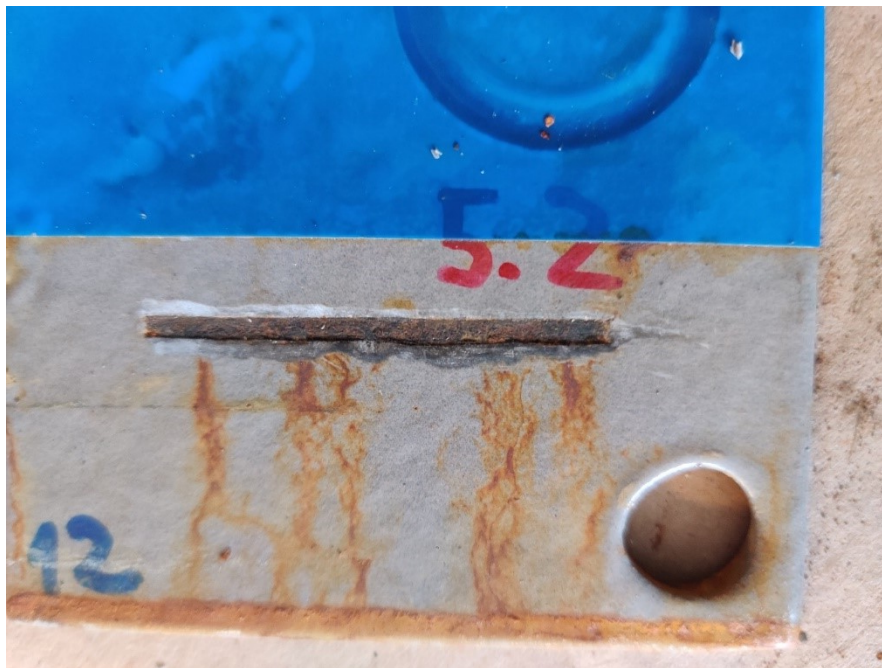
Slika 31. Očišćeno mjesto zareza na uzorku 12
