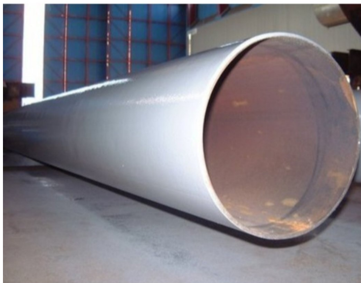
Slika 14. Epoksidni premazom sa staklenim česticama nanosen na čeličnu cijev [29]
