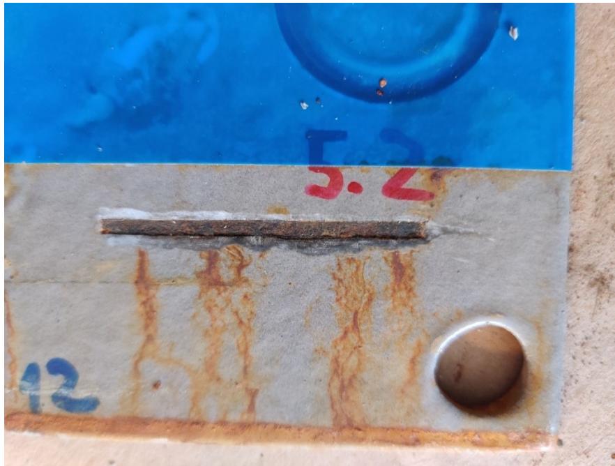
Slika 31. Očišćeno mjesto zareza na uzorku 12
