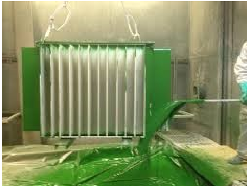
Slika 21. Postupak prelijevanja dijela transformatora [40]
