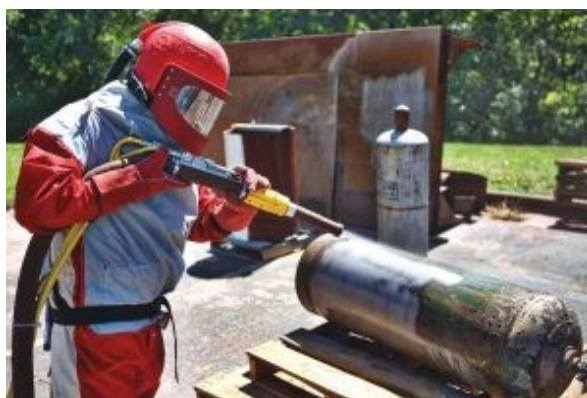
Slika 16. Čišćenje suhim mlazom abraziva [35]
