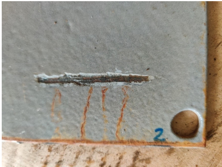
Slika 29. Očišćeno mjesto zareza na uzorku 2
