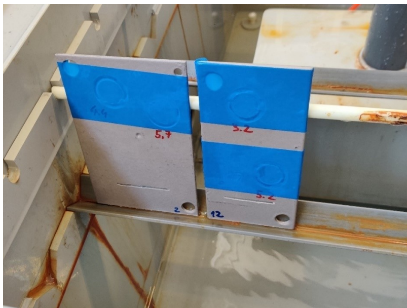
Slika 27. Uzorci 2 i 12 prije ispitivanja u slanoj komori
