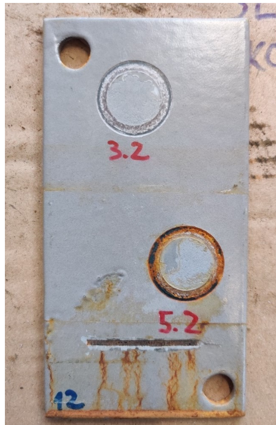
Slika 32. Uzorak 12 - izgled površine za ispitivanje stupnja mjehuravosti i hrđanja
