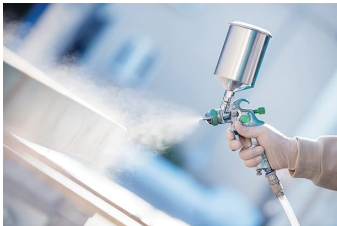
Slika 18. Pištolj korišten za zračno prskanje [37]
