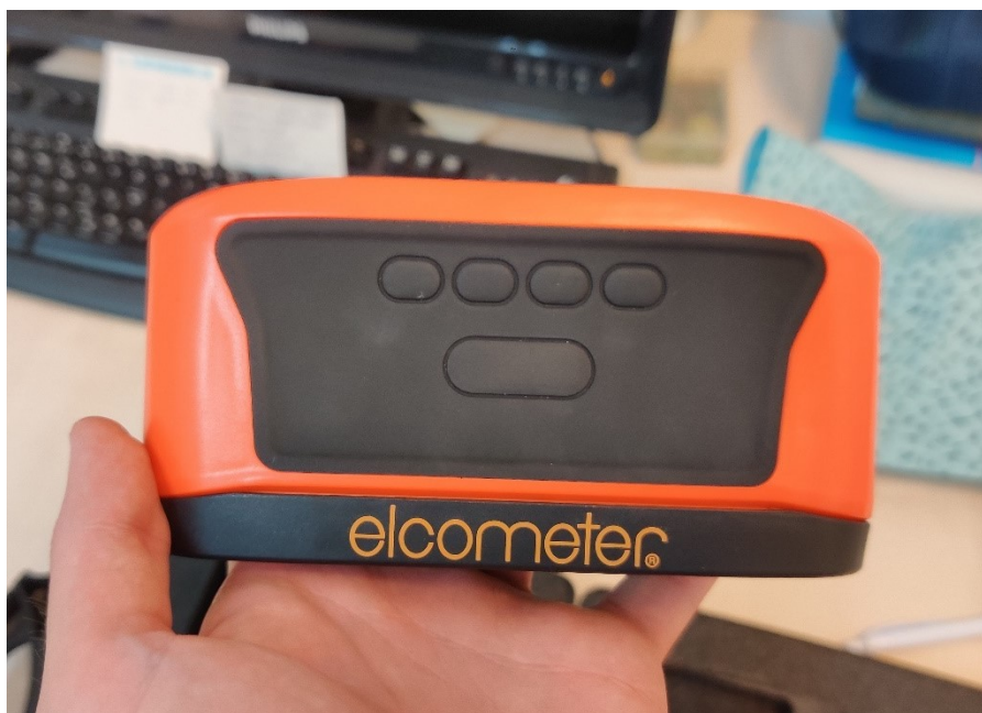
Slika 25. Elcometer 480 uređaj za mjerenje sjaja premaza
