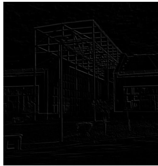
Slika 15. Konvolucija matrice 2x2 po osi y
