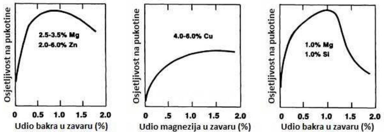
Slika 32. Osjetljivost na stvaranje pukotina aluminijskih legura sa više legirnih elemenata [27]
