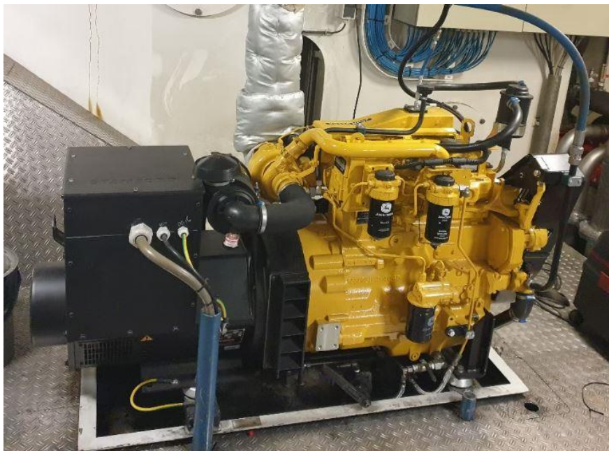
Slika 7. Primjer motora kategorije IWA – John Deere brodski Dieslov motor [7]
