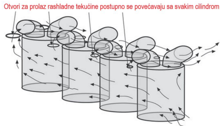
Slika 18. Serijski tok rashladne tekućine za redni 4-cilindarski motor [8]
