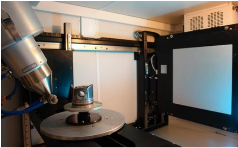
Slika 6 Primjer industrijskog CT uređaja – unutarnji dijelovi [8]
