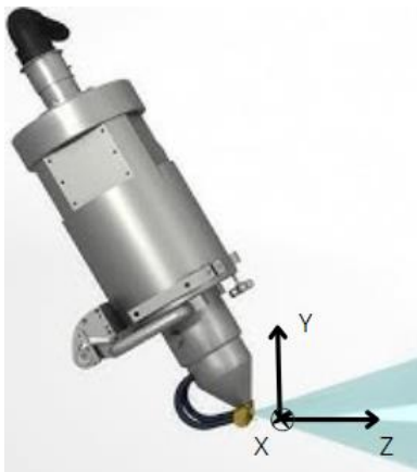
Slika 11 X, Y, Z ravnina CT skenera
