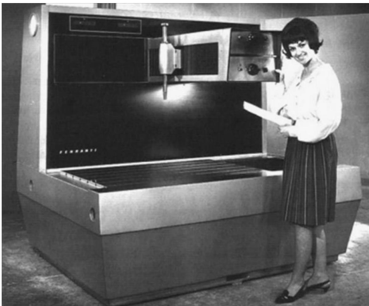
Slika 1. Trokoordinatni mjerni uređaj tvrtke Ferranti [1]
