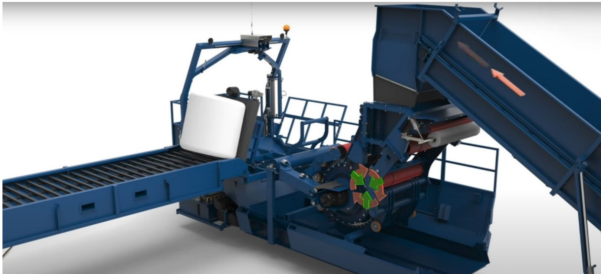
Slika 12. Prikaz prebacivanja bale na transportnu traku [11]
