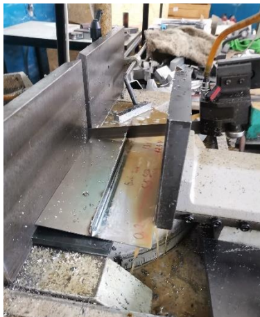
Slika 73. Rezanje makroizbrusaka na tračnoj pili
