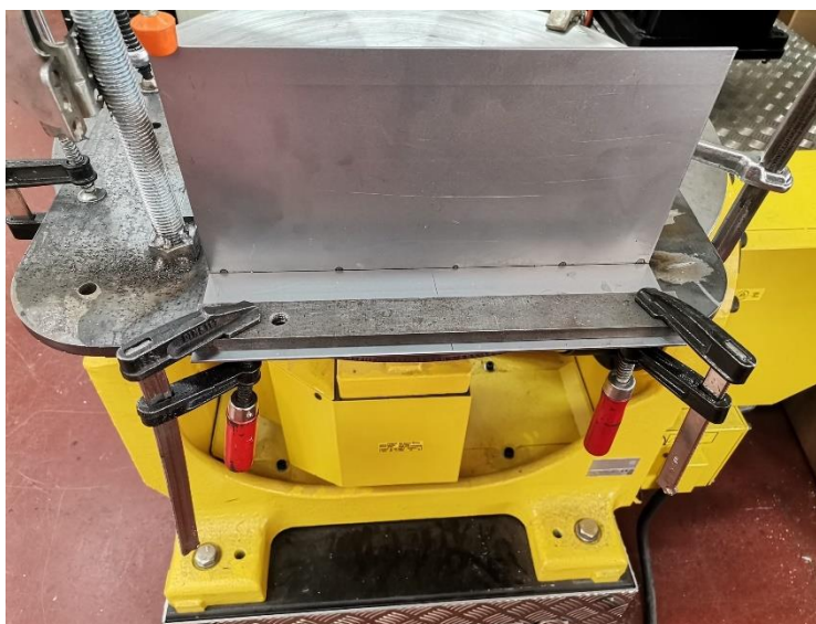
Slika 56. Stezanje testnih uzoraka na pozicioner robota
