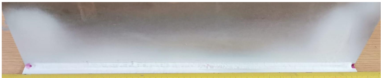
Slika 66. Pregled indikacija pukotina na uzorku 1
