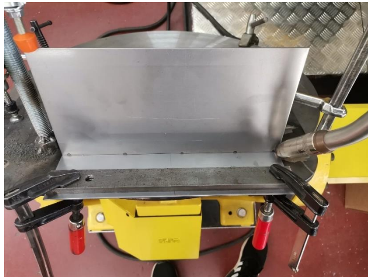
Slika 58. Položaj pištolja za zavarivanje – lijeva tehnika rada
