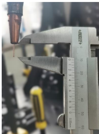
Slika 54. Mjerenje duljine slobodnog kraja žice
