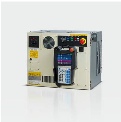
Slika 40. R-30iB upravljačka jedinica s privjeskom za učenje [32]
