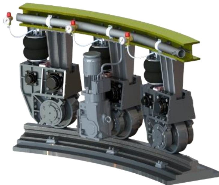
Slika 46. Render pogonskog i nosivog člana ovjesa, [12]
