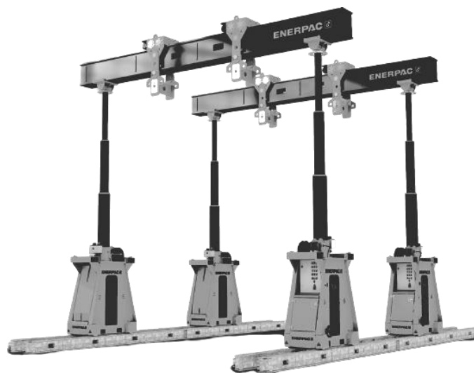
Slika 5. Hidraulička dizalica s prihvatom u četiri točke, [5]
