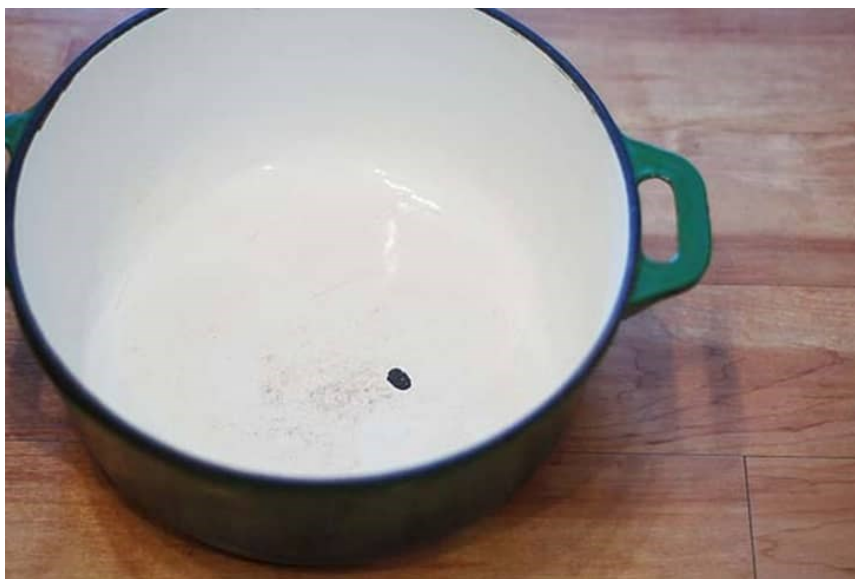
Slika 20. Pukotina na emajliranom metalnom loncu [40]
