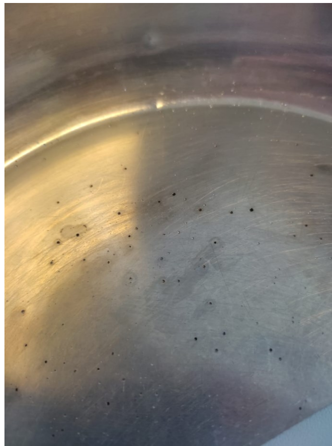
Slika 17. Pojava rupičaste korozije na površini posuđa od nehrđajućeg čelika
