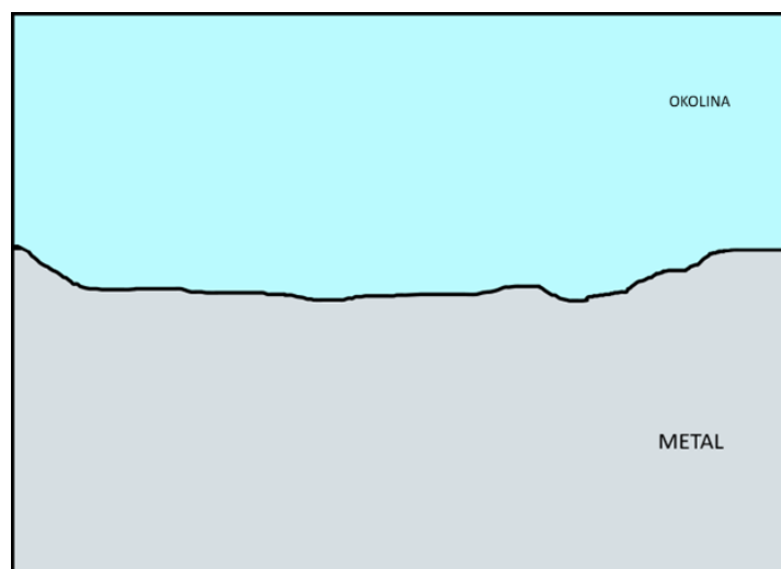
Slika 2. Skica opće korozije [7]
