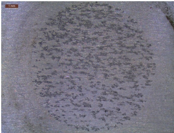
Slika 54. Snimke ispitnih uzoraka testiranih u destiliranoj otopini 3,5% i 5,0% NaCl
