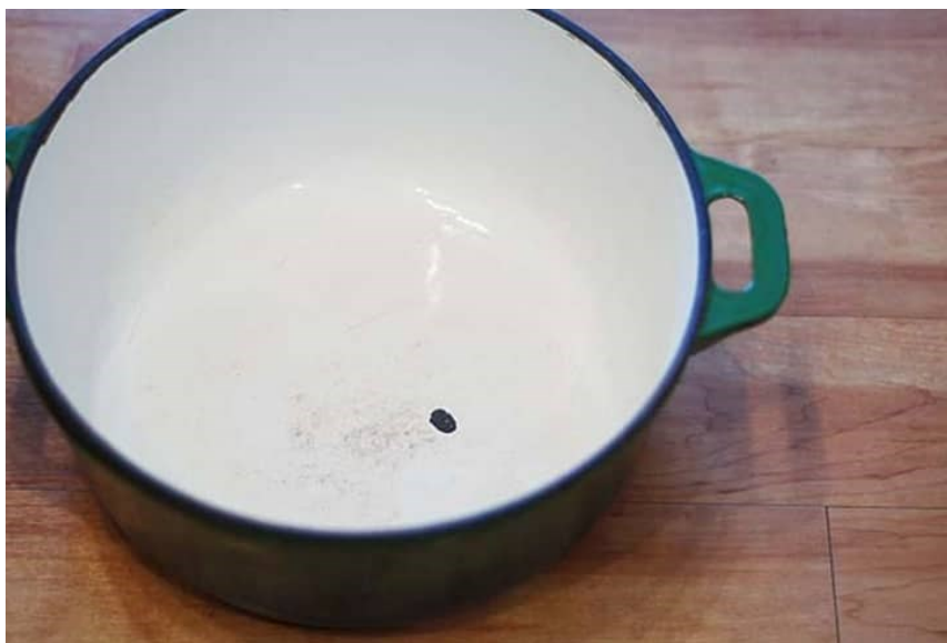
Slika 20. Pukotina na emajliranom metalnom loncu [40]
