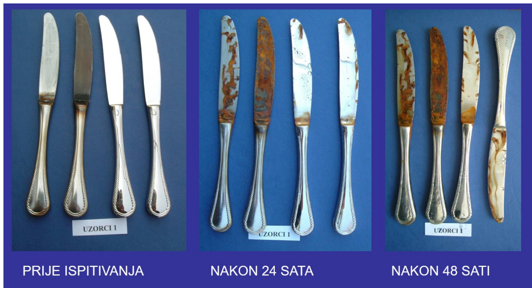
Slika 16. Korozijsko trošenje kuhinjskih noževa od nehrđajućeg čelika ispitivanjem u slanoj komori (Laboratorij za zaštitu materijala, FSB)
