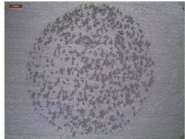
Slika 54. Snimke ispitnih uzoraka testiranih u destiliranoj otopini 3,5% i 5,0% NaCl
