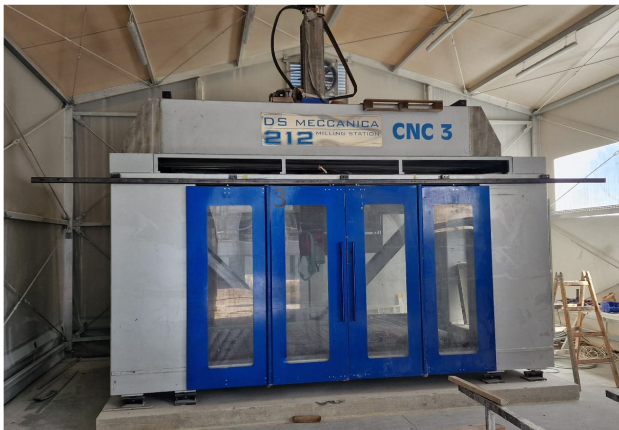
Slika 4. 5-osni obradni centar DS Meccanica tipa DS212/5
