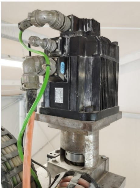
Slika 13. Pogonski motor posmičnog prigona Z osi
