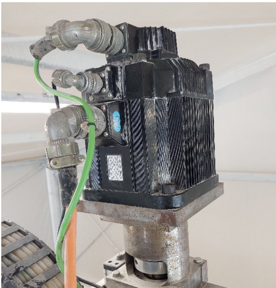
Slika 14. Pogonski PMSM motor posmičnog prigona Z osi
