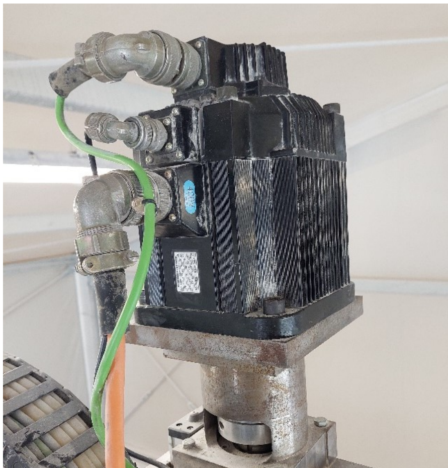
Slika 14. Pogonski PMSM motor posmičnog prigona Z osi
