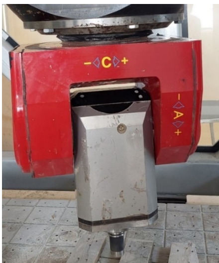
Slika 11. Rotacijske osi stroja
