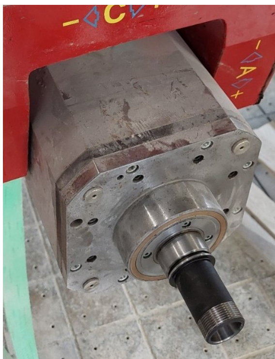
Slika 15. Motorvreteno obradnog centra
