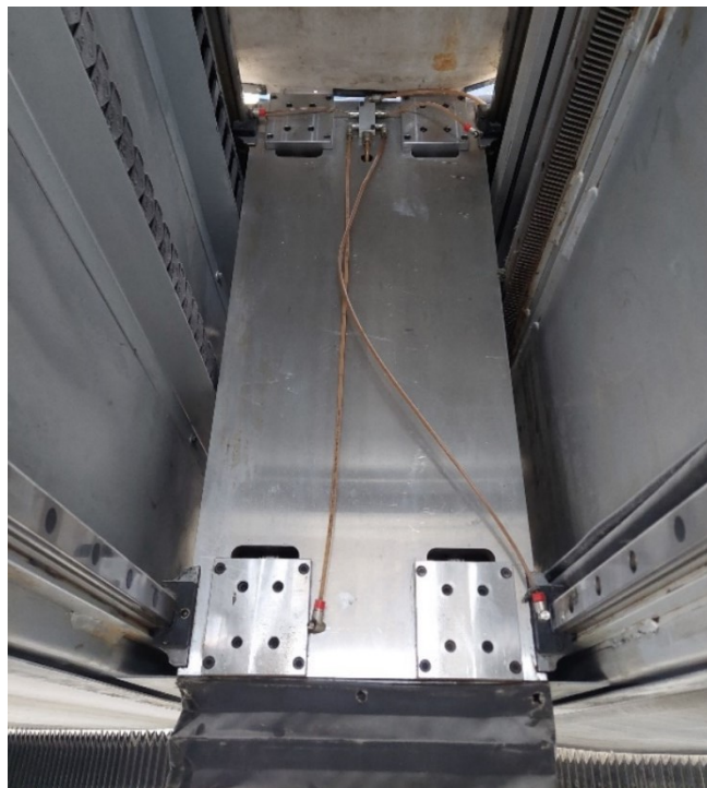
Slika 25. Podmazivanje klizača i linearnih vodilica
