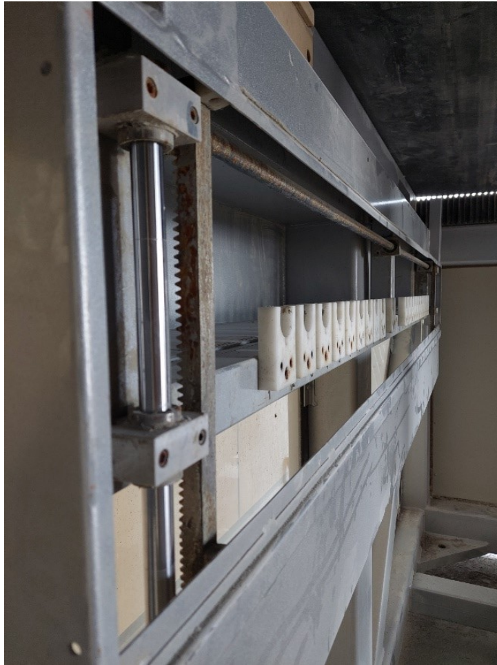
Slika 17. Mehanizam za osiguravanje sinkroniziranog rada pneumatskih cilindara
