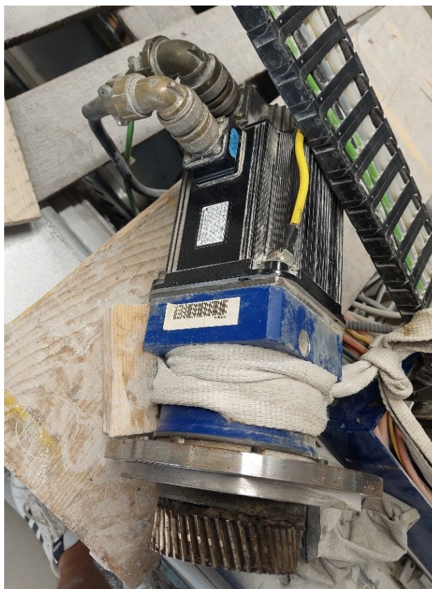
Slika 13. Pogonski PMSM motor, reduktor i zupčanik posmičnog prigona X osi
