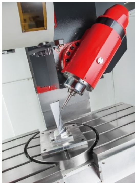
Slika 7. Okretni radni stol i nagibni posmični prigon glavnog vretena [10]
