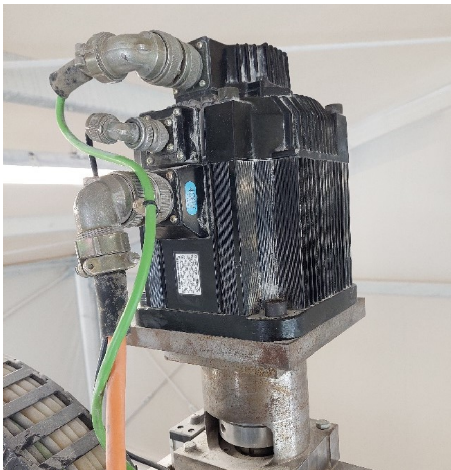
Slika 14. Pogonski PMSM motor posmičnog prigona Z osi
