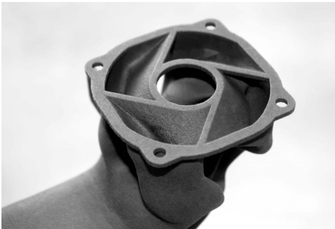
Slika 21. 3D ispisan model MJF tehnologijom [27]
