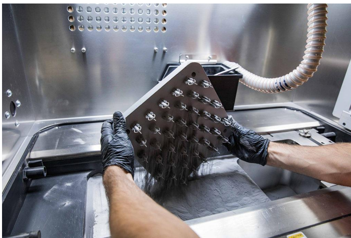
Slika 18. Modeli ispisani DMLS tehnikom [24]
