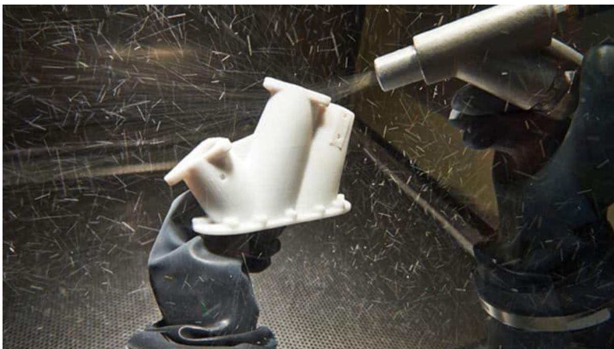
Slika 4. Završna obrada modela pjeskarenjem [6]
