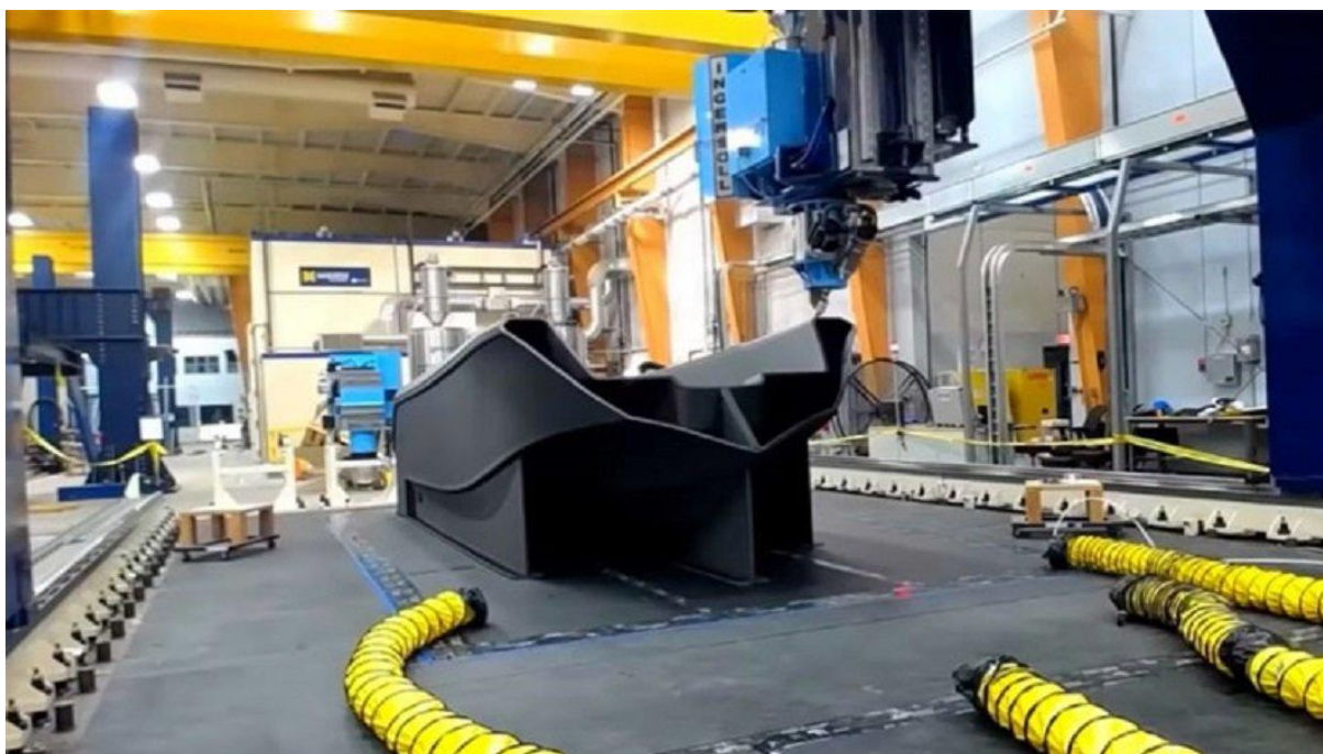
Slika 16. 3D ispisan trup plovila [21]
