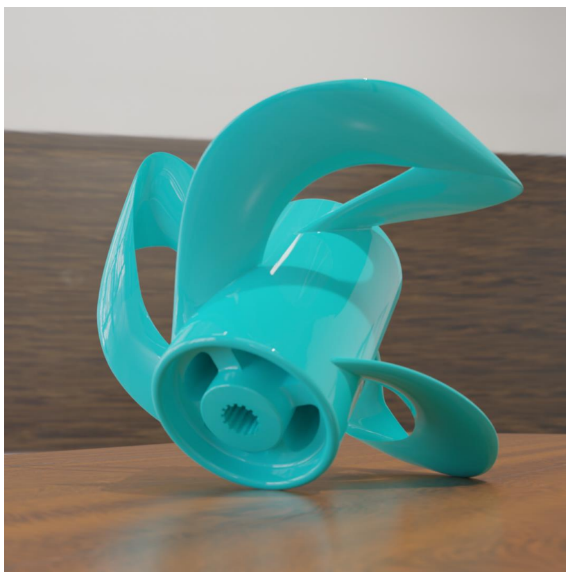
Slika 25. 3D ispisan toroidalni propeler [36]
