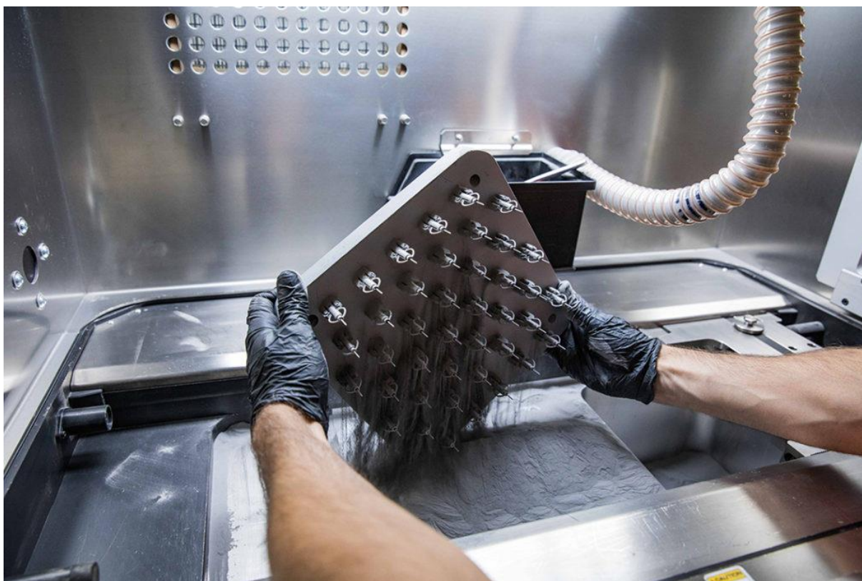
Slika 18. Modeli ispisani DMLS tehnikom [24]
