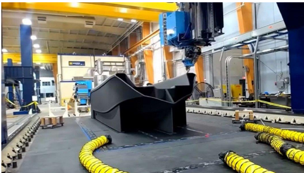
Slika 16. 3D ispisan trup plovila [21]
