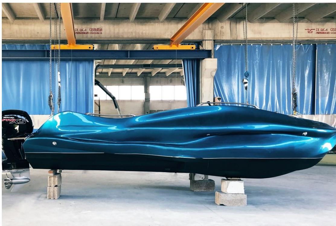
Slika 24. 3D ispisan gliser od staklenih vlakna [33]
