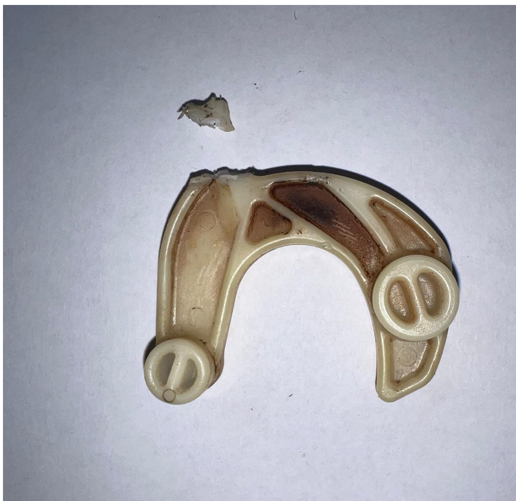
Slika 43. Prikaz neispravnog dijela uz odlomljeni dio
