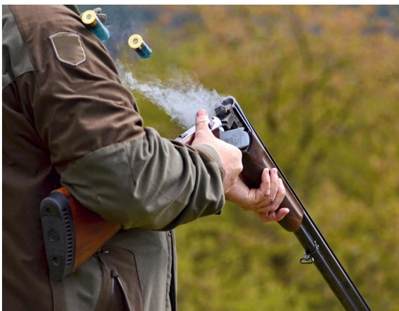
Slika 23. Ejektor izbacuje obje opaljene čahure [23]
