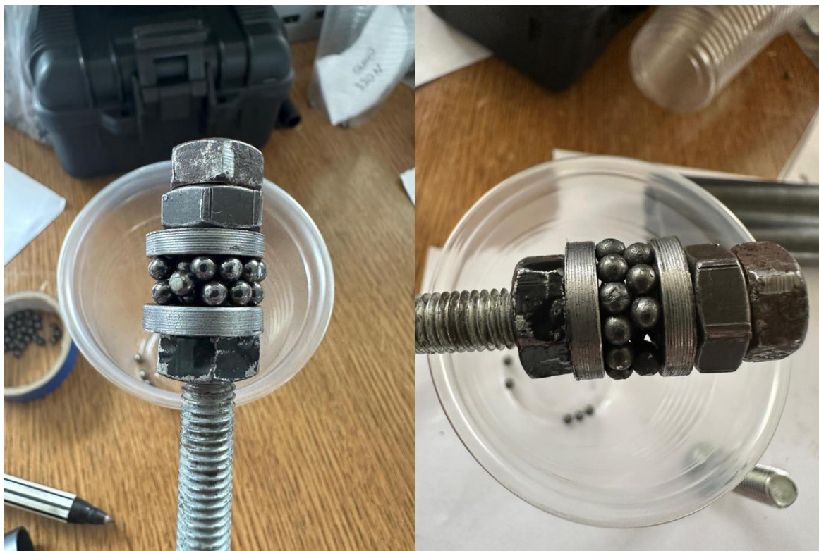
Slika 44. Usporedni prikaz olovne (lijevo) i čelične (desno) sačme nakon ispitivanja
