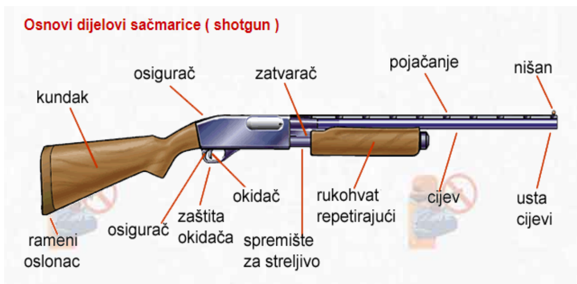
Slika 13. Prikaz osnovnih dijelova sačmarice [17]
