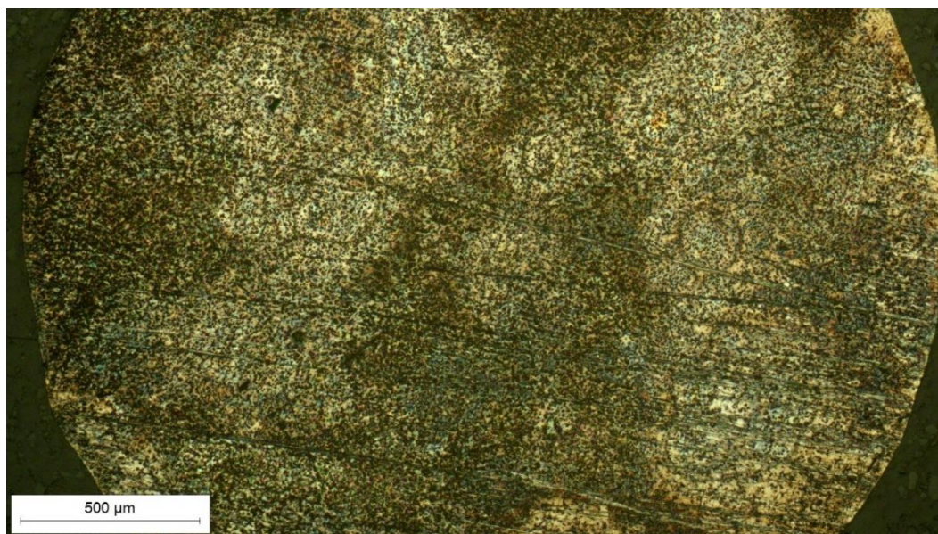
Slika 48. Mikrostruktura olovne sačme pri povećanju od 50x
