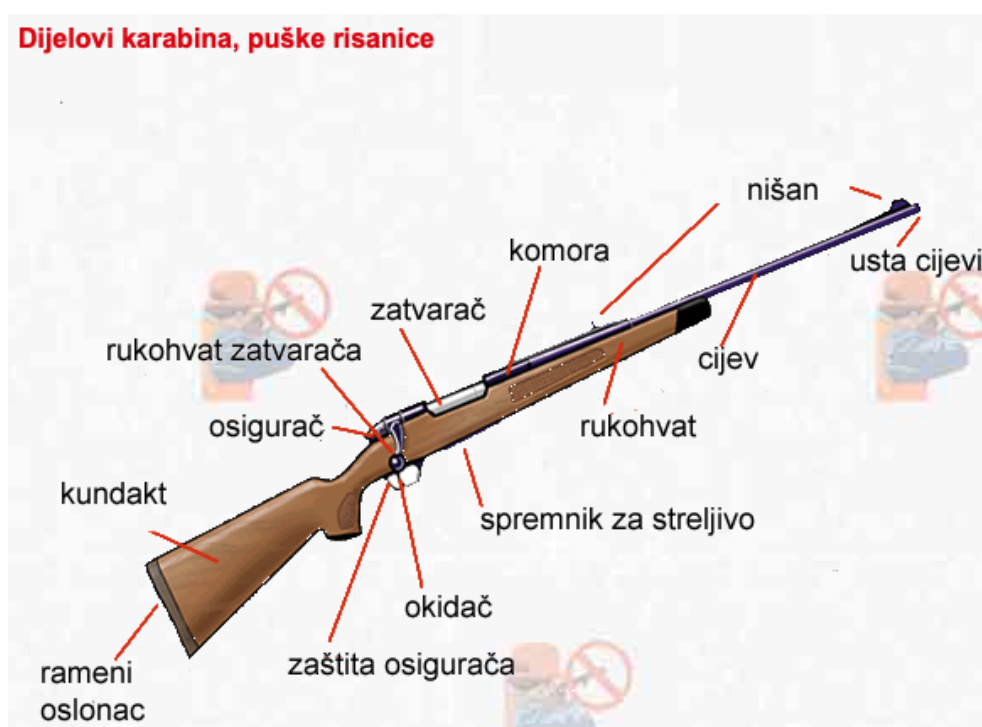
Slika 25. Prikaz osnovnih dijelova karabina/kuglara[17]
