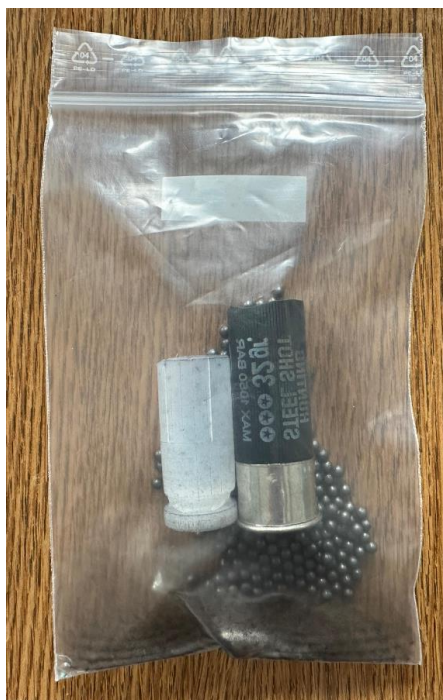
Slika 29. Prikaz čelične sačme i plastične košarice
