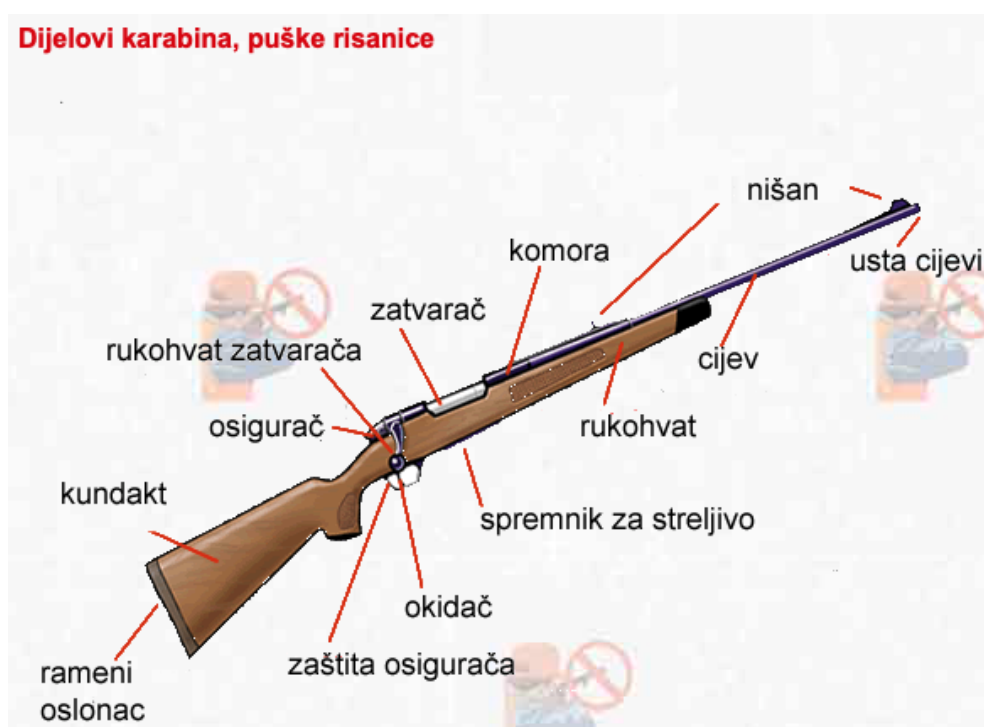
Slika 25. Prikaz osnovnih dijelova karabina/kuglara[17]
