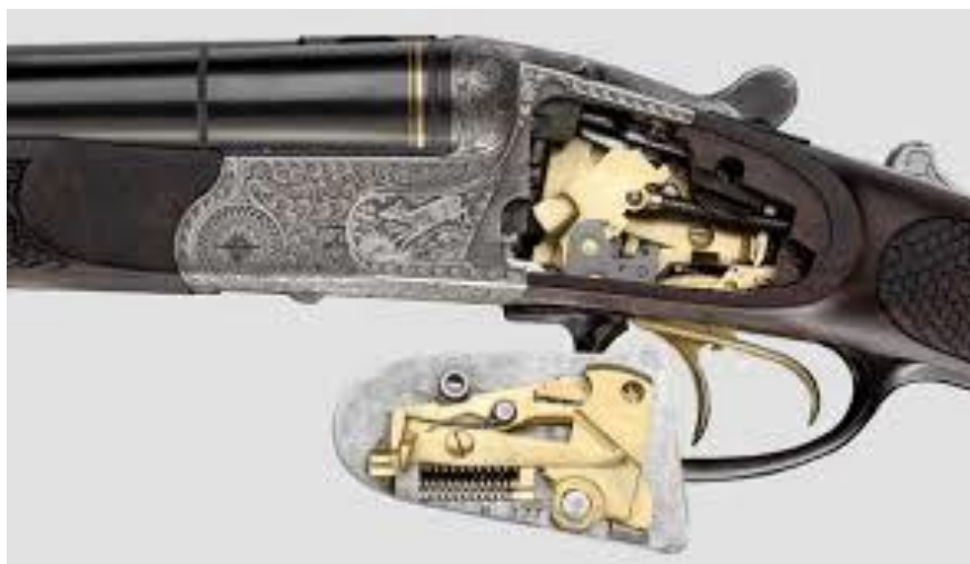
Slika 22. Prikaz mehanizma za opaljenje [22]
