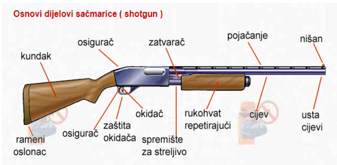
Slika 13. Prikaz osnovnih dijelova sačmarice [17]
