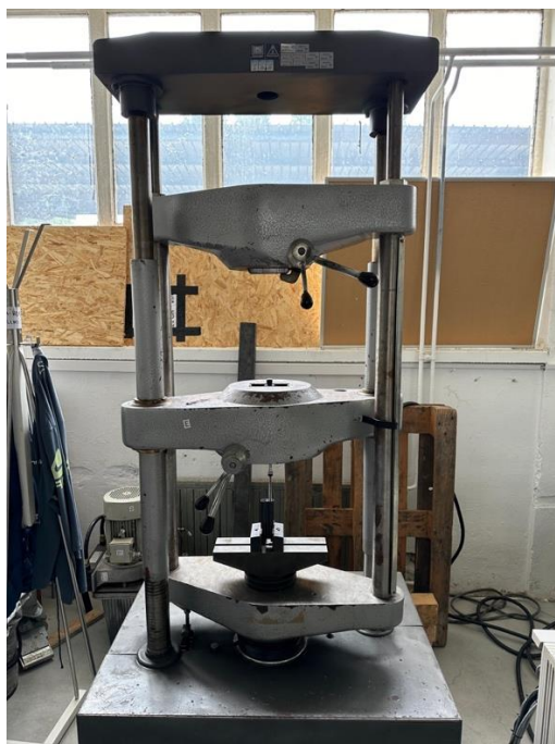
Slika 33. Kidalici WPM Leipzig EU 40 mod
