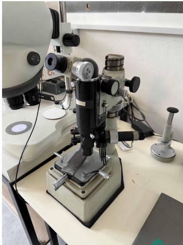
Slika 43. Uređaj za mjerenje tvrdoće
