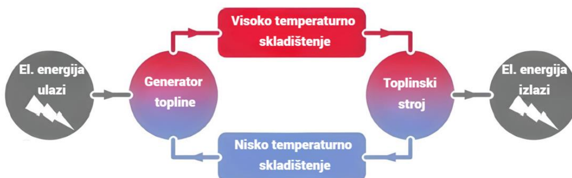
Slika 1 Pojednostavljena shema sustava Carnotove baterije [2]
