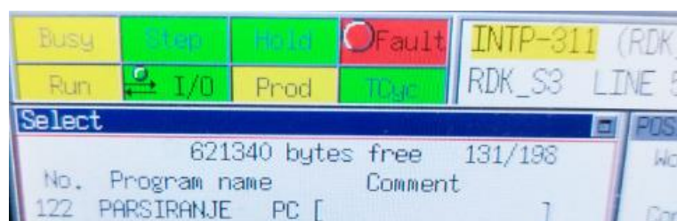
Slika 13. Privjesak za učenje javlja greški i potrebno je napraviti „reset“ (slika autora)
