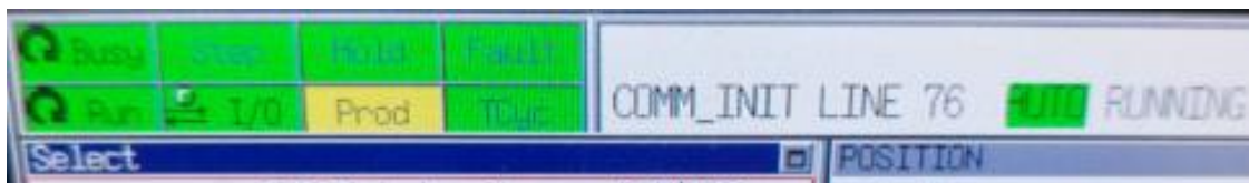
Slika 12. Privjesak za učenje ne javlja greške i robot je spreman za rad (slika autora)
