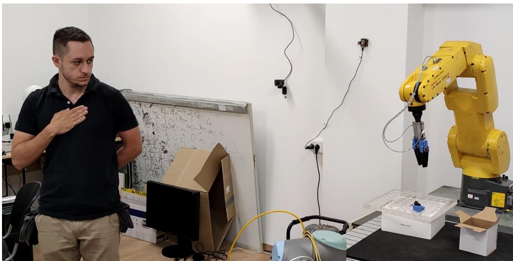
Slika 26. Korisnik miruje s fiksiranom rukom – testiranje najmanjih pokreta zbog šuma sustava (slika autora)
