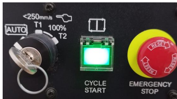
Slika 14. Upravljačka ploča robota spremnog za rad (slika autora)
