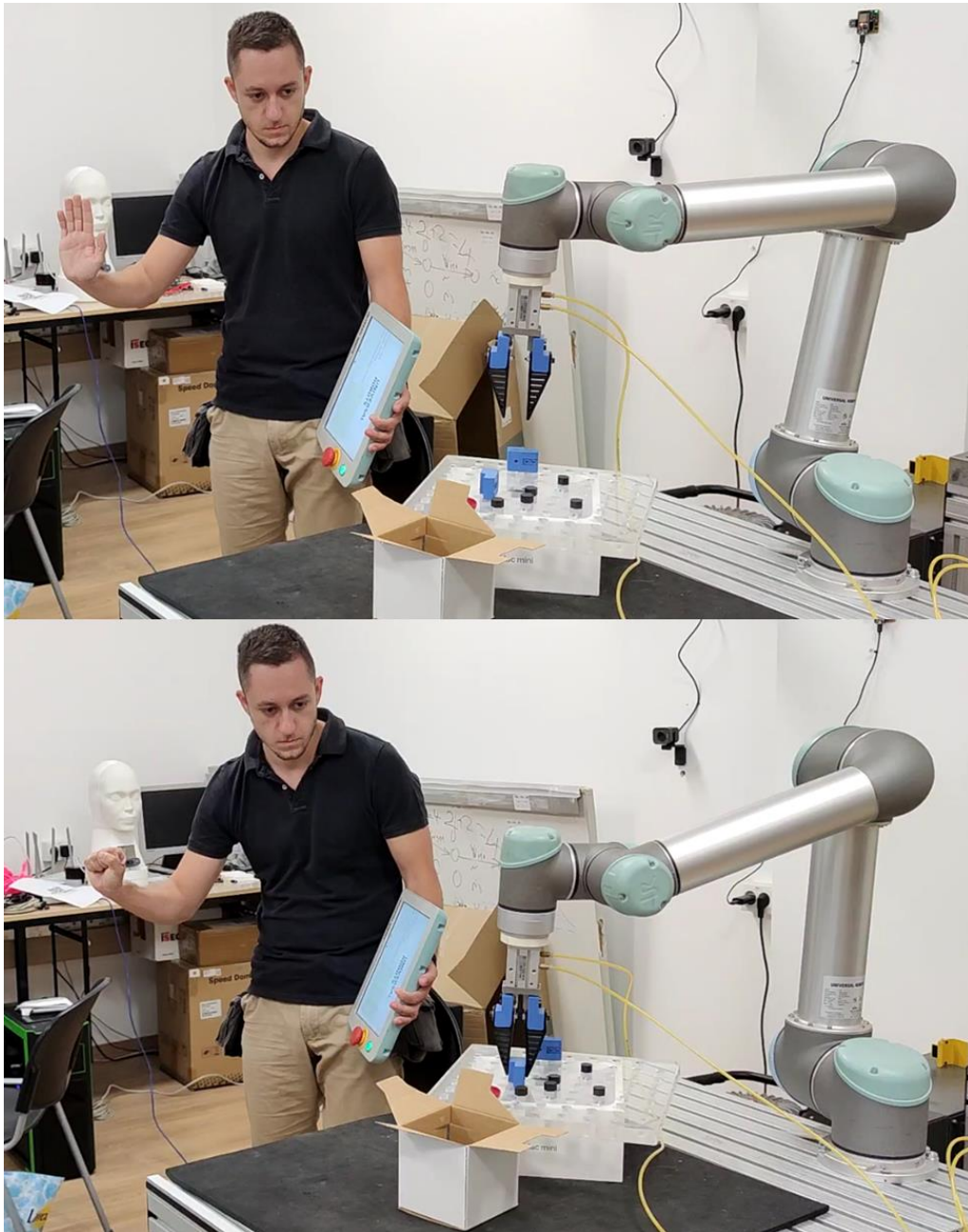
Slika 29. Testiranje kobota UR5 – pozicioniranje i izuzimanje predmeta (slika autora)
