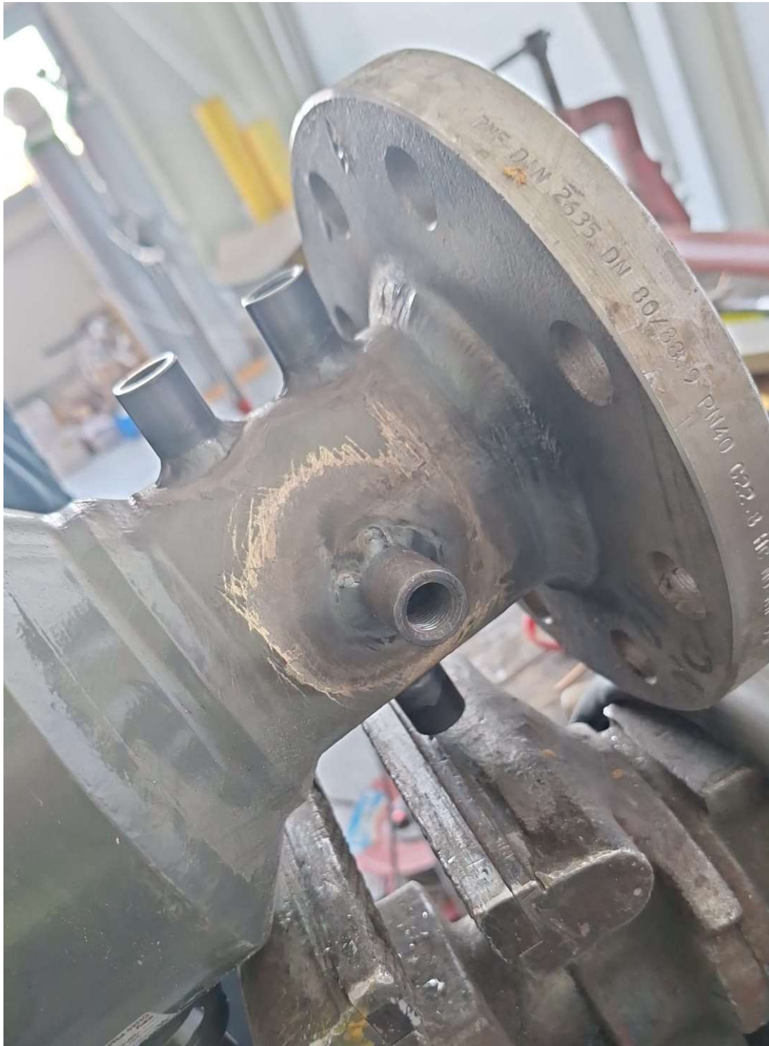
Slika 26. Zavareni priključci na tijelo ventila
