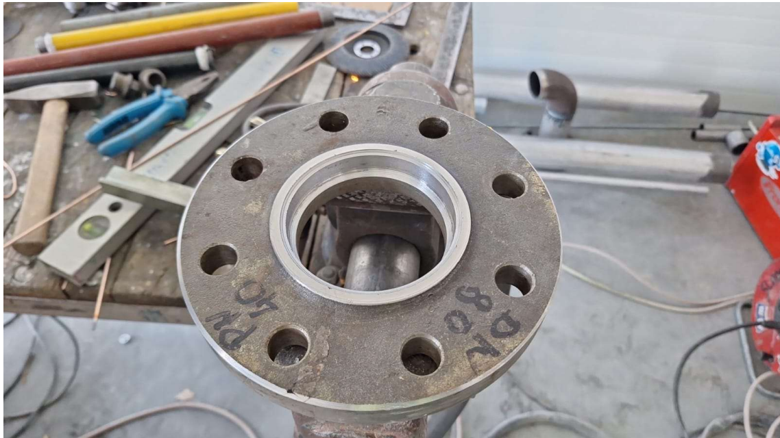
Slika 20. Priprema prirubnice za zavarivanje
