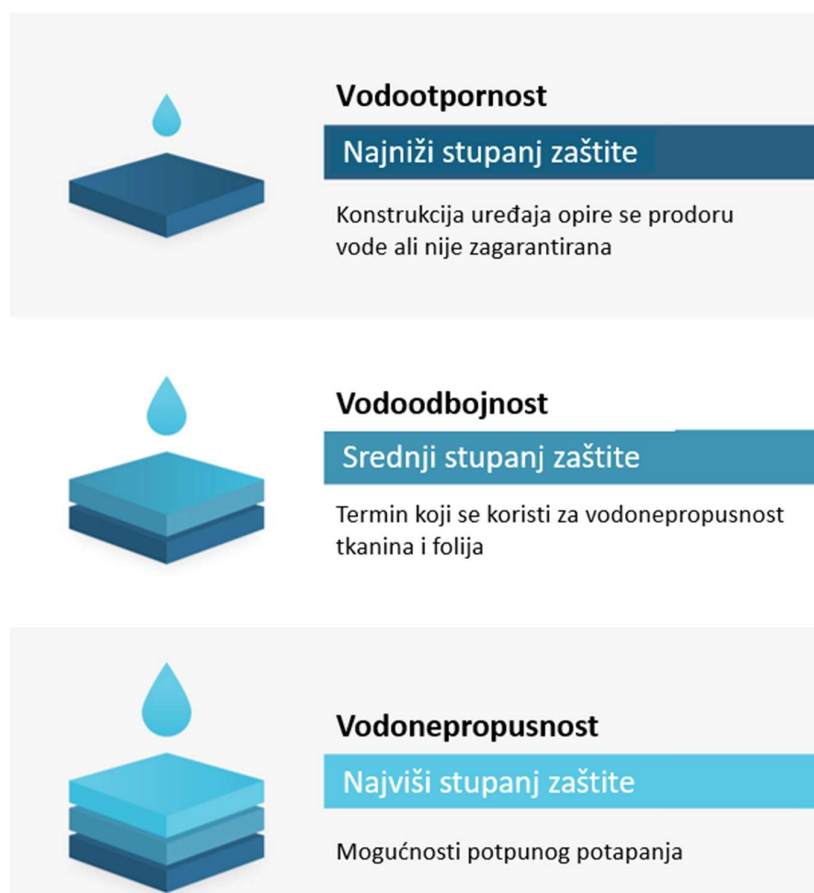
Slika 1. Shematski prikaz stupnjevanja vodootpornosti, vodoodbojnosti i vodonepropusnosti
