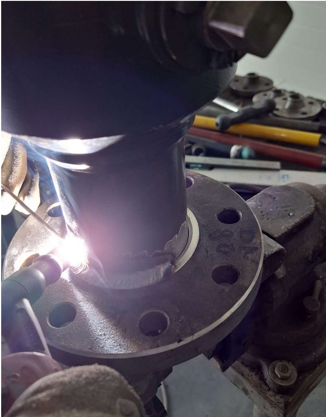
Slika 23. Zavarivanje TIG postupkom
