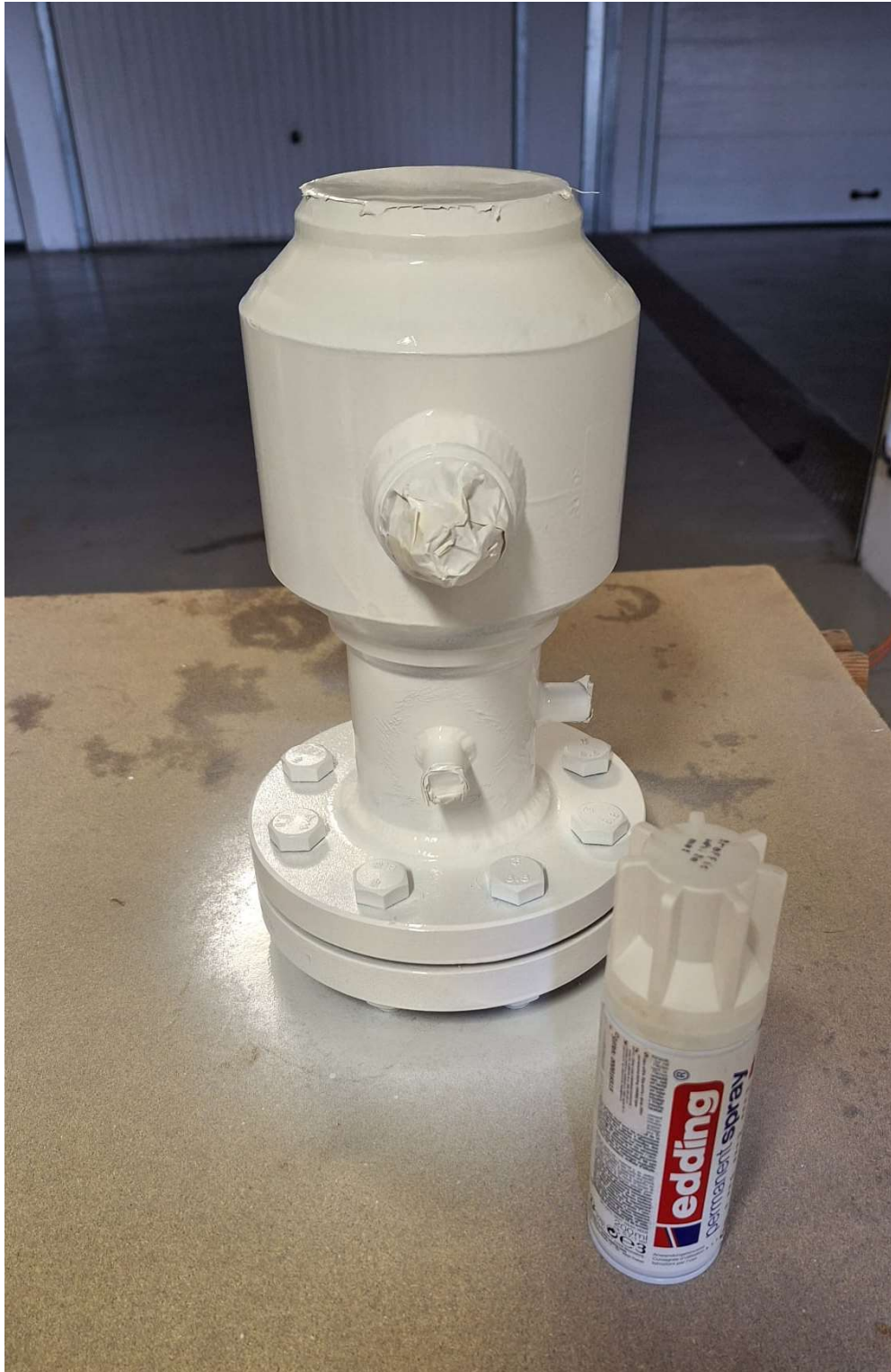
Slika 27. Komora nakon završnog premaza
