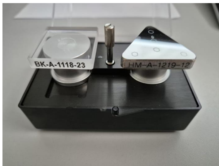
Slika 22. Prijenosni etaloni za kalibraciju uređaja
