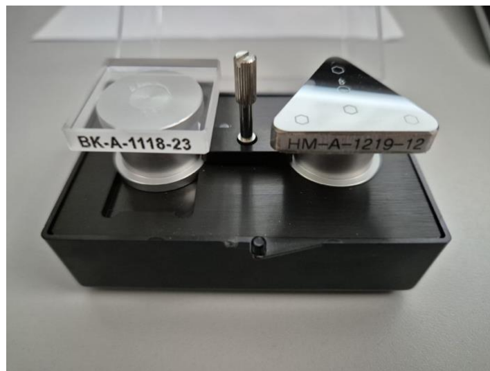
Slika 22. Prijenosni etaloni za kalibraciju uređaja
