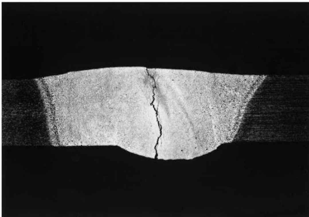
Slika 2. Prikaz tople pukotine nastale tijekom zavarivanja aluminija [5]
