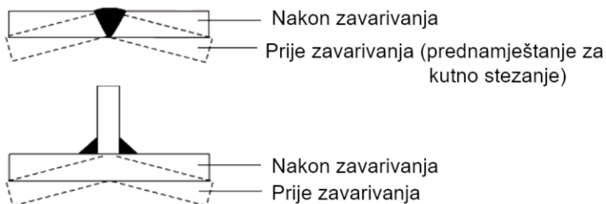
Slika 33. Pred namještanje radnog komada[28]
