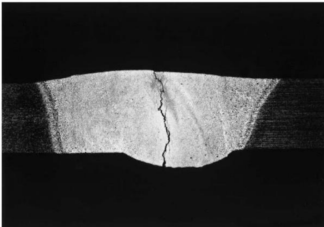
Slika 2. Prikaz tople pukotine nastale tijekom zavarivanja aluminija [5]
