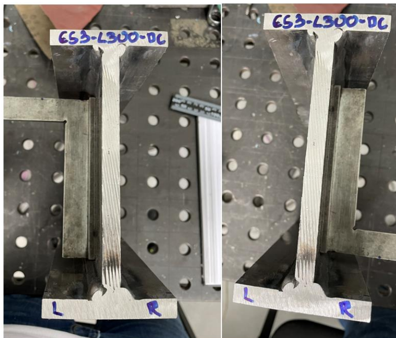
Slika 43. Vizualna kontrola deformacija ispitnih uzoraka
