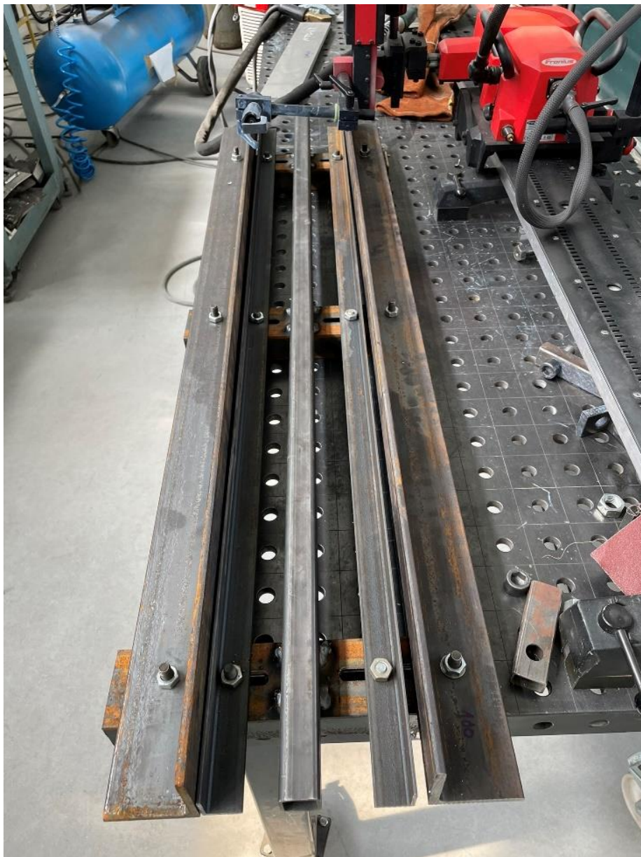
Slika 39. Naprava za stezanje pripremljena za zavarivanje
