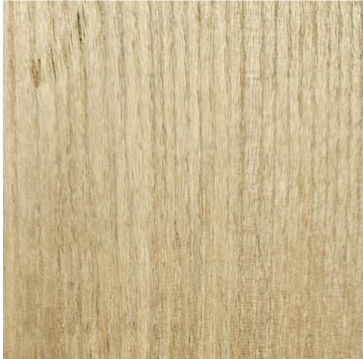
Slika 23. Radijalni presjek subfosilnog jasena
