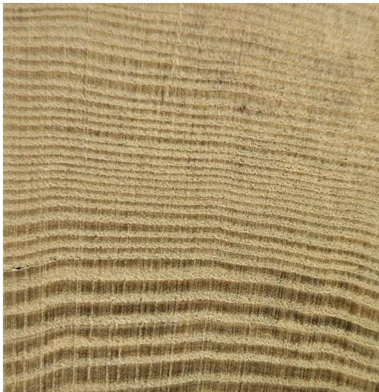
Slika 21. Poprečni presjek subfosilnog jasena
