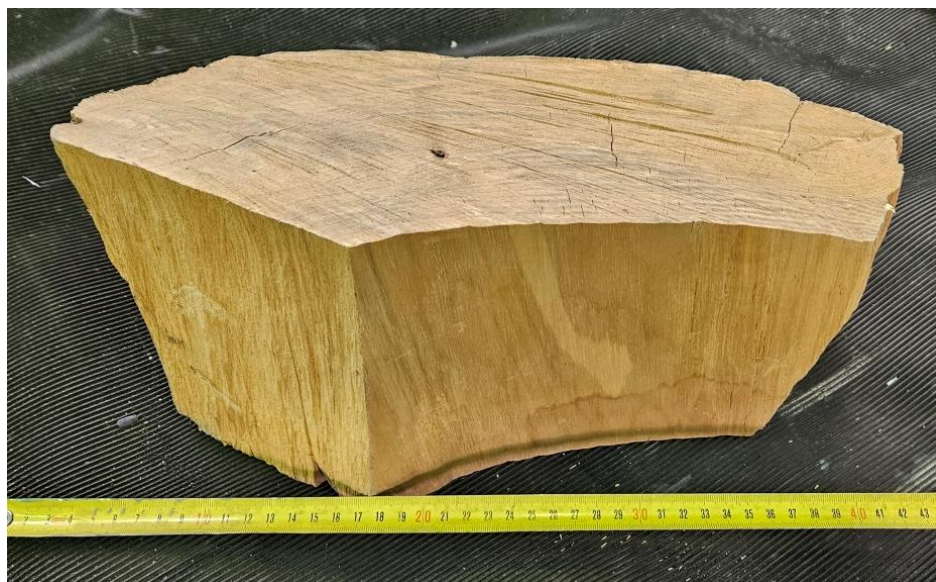
Slika 19. Dio trupca jasena iz kojeg su uzeti uzorci za sva ispitivanja
