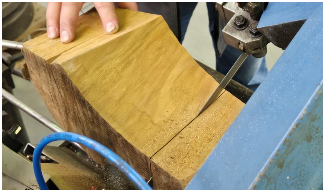
Slika 20. Piljenje jasena na manje komade
