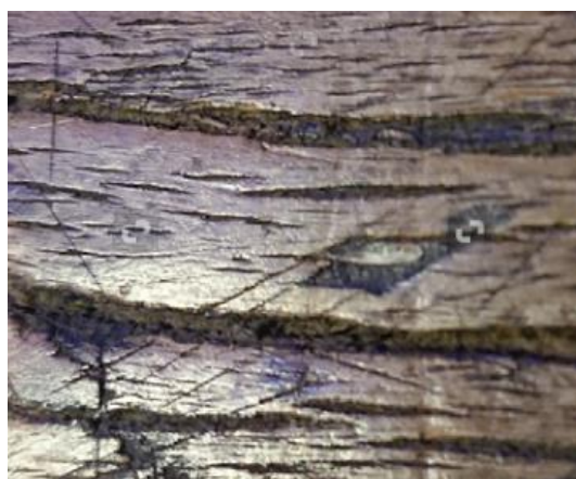
Slika 17. Oštećenja na površini drva izazvana abrazijom [25]
