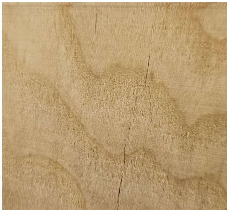
Slika 22. Tangencijalni presjek subfosilnog jasena
