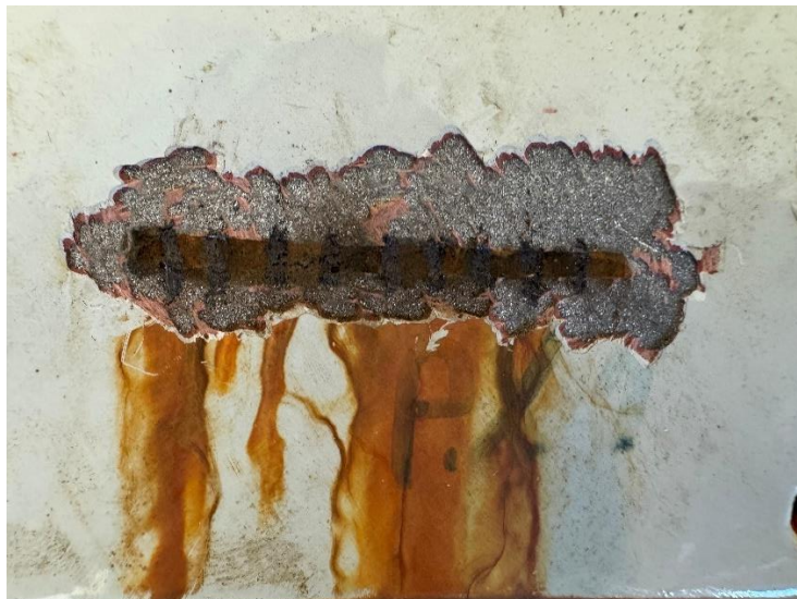
Slika 34. Zarez kod uzorka PX1 nakon što je uklonjen premaz oko samog zareza
