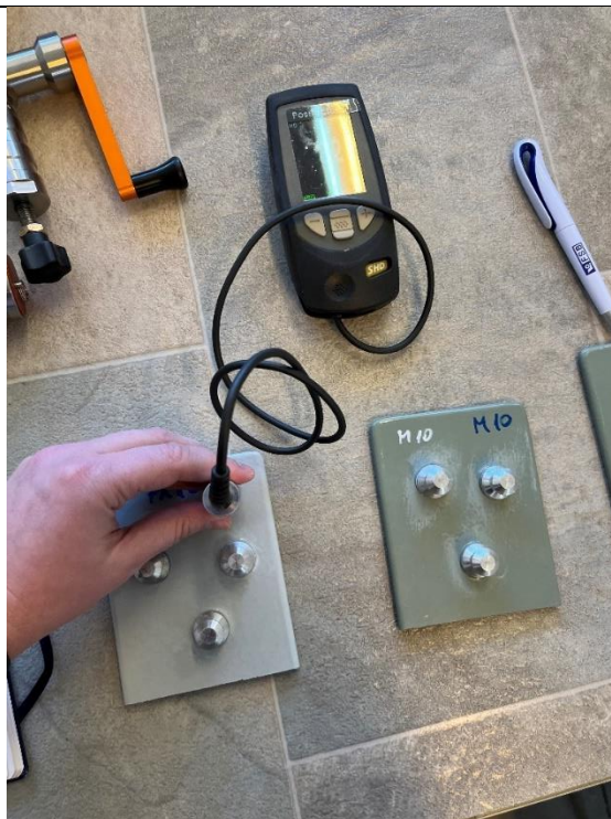
Slika 24. Mjerenje tvrdoće uzorka PX10
