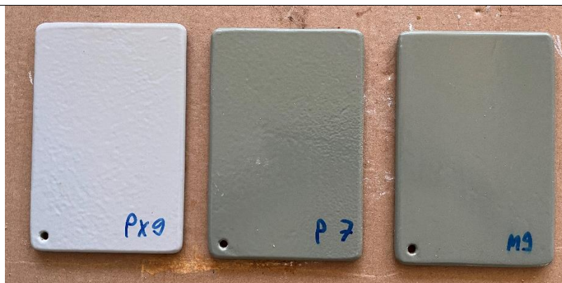
Slika 31. Uzorci nakon 960 sati u vlažnoj komori
