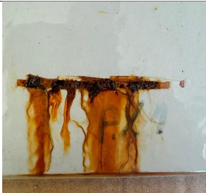
Slika 33. Zarez kod uzorka PX1 nakon 720 h u slanoj komori
