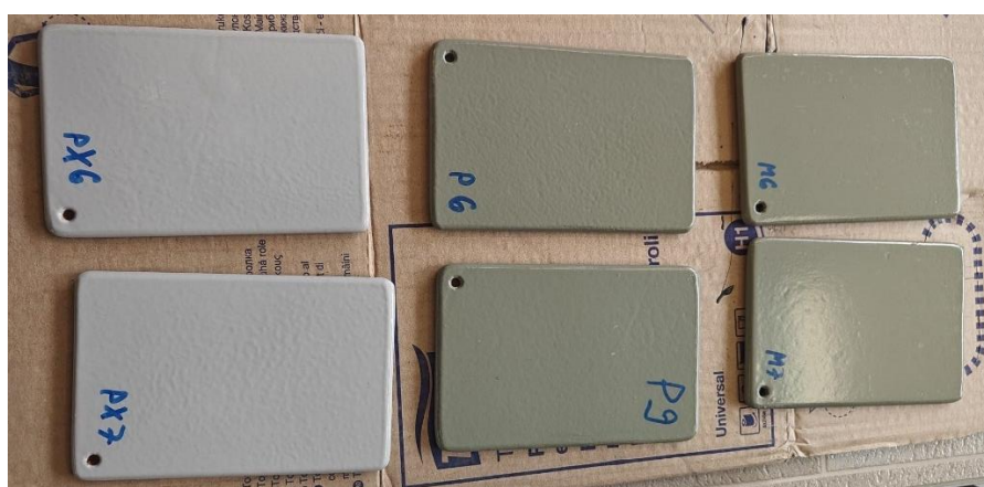
Slika 30. Uzorci nakon 480 h vlažne komore
