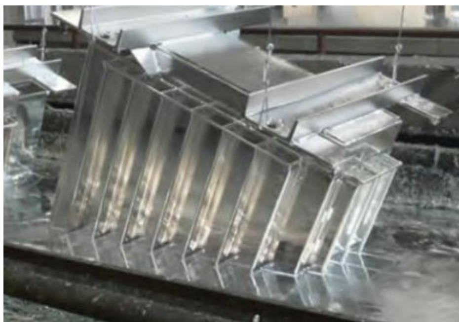
Slika 8. Vruće cinčanje transformatorskog kotla [6]
