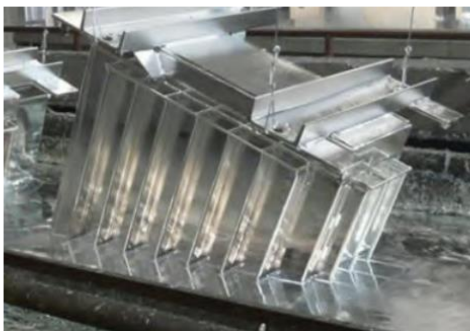
Slika 8. Vruće cinčanje transformatorskog kotla [6]
