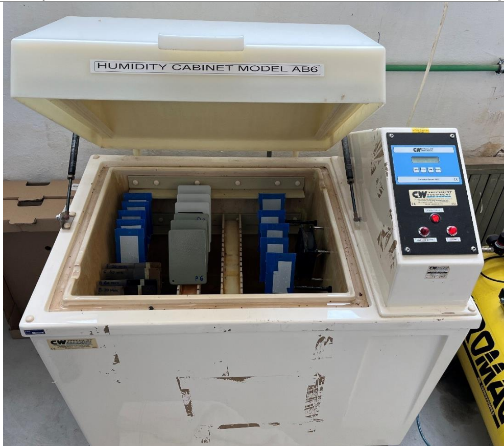
Slika 29. Vlažna komora Katedre za zaštitu materijala FSB-a
