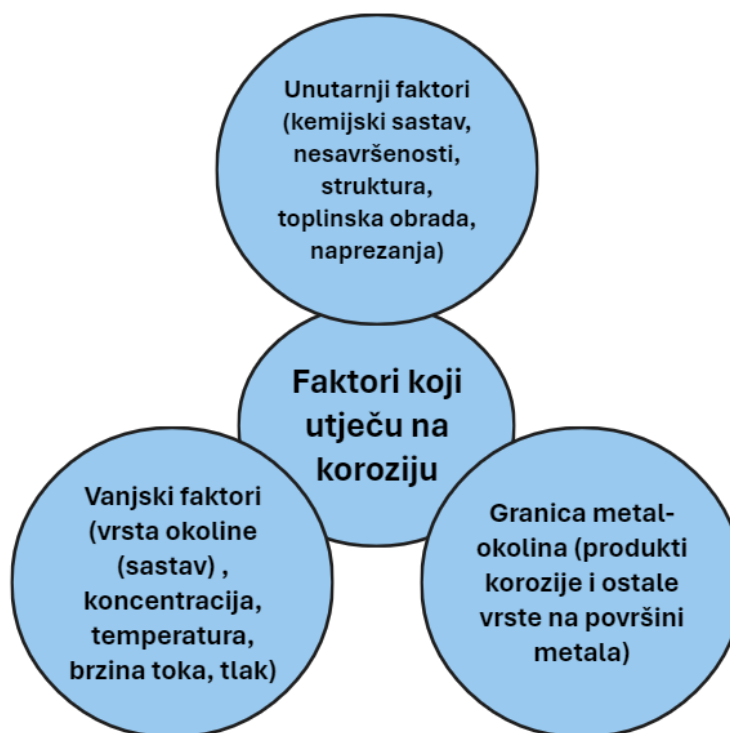
Slika 2. Popis faktora koji utječu na koroziju
