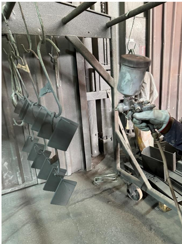
Slika 19. Nanošenje temeljnog sloja premaza na uzorke P i PX
