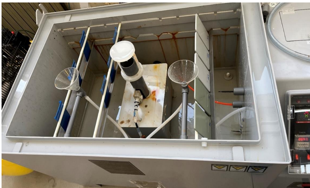
Slika 26. Slana komora Katedre za zaštitu materijala FSB-a
