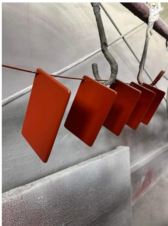
Slika 20. Nanošenje međupremaza na uzorke P i PX
