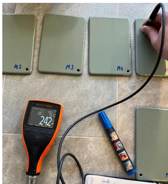
Slika 22. Ispitivanje debljine premaza
