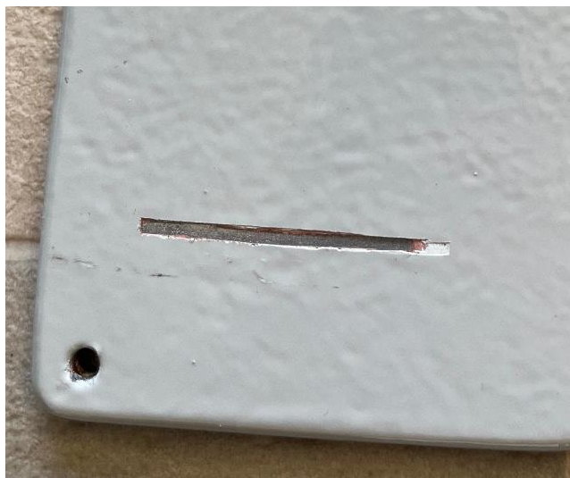
Slika 32. Urezan zarez kod uzorka PX1
