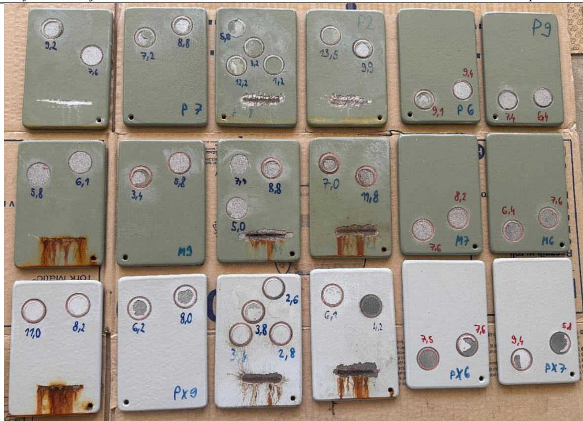
Slika 35. Svi uzorci podvrgnuti slanoj i vlažnoj komori
