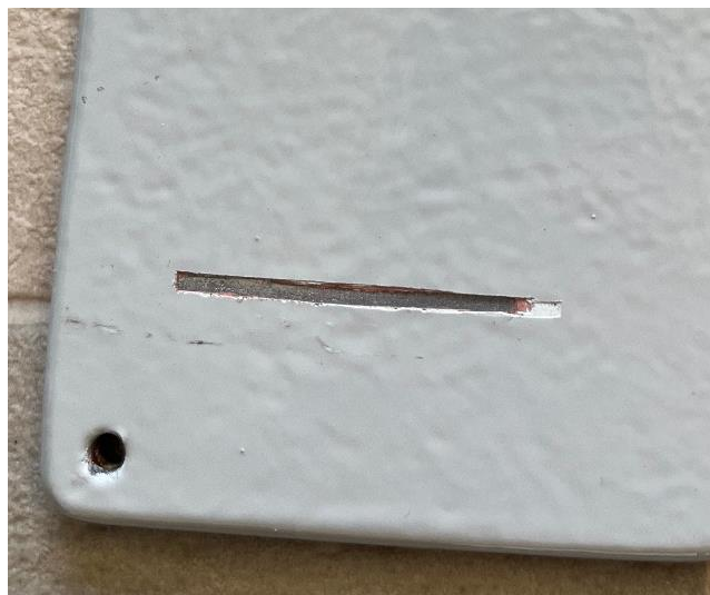
Slika 32. Urezan zarez kod uzorka PX1
