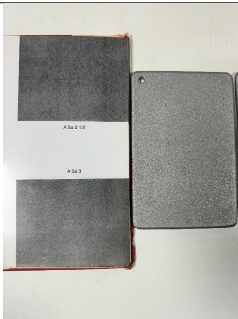
Slika 14. Određivanje stupnja pripreme površine uzorka
