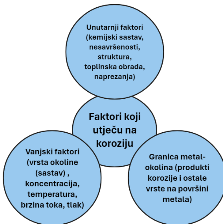
Slika 2. Popis faktora koji utječu na koroziju
