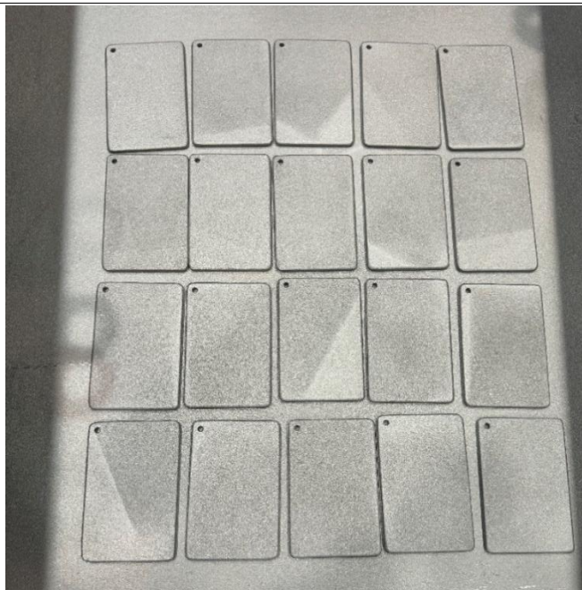
Slika 12. Pripremljeni uzorci od ugljičnog čelika S235
