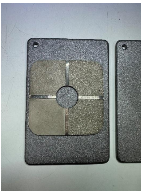
Slika 13. Usporedba pripremljene površine uzorka sa komparatorom hrapavosti
