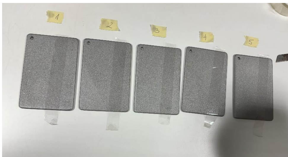
Slika 15. Korištenje ljepljive trake za test prašine
