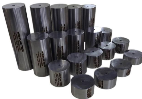
Slika 6. Kalibracijski blokovi s uvrtime s ravnim dnom [6]
