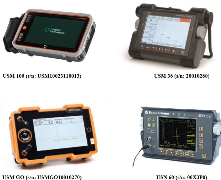
Slika 8. Ultrazvučni uređaji korišteni u provedbi mjerenja [9]
