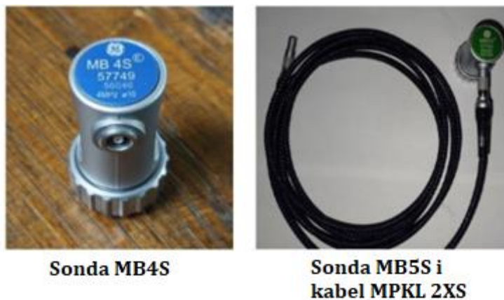
Slika 9. Ultrazvučne sonde korištene u provedbi mjerenja [9]
