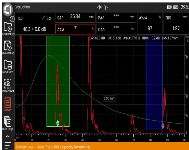
Slika 28. A-prikaz - USM 100 – MB5S – 5 0100
