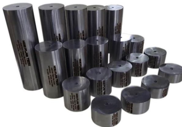
Slika 6. Kalibracijski blokovi s uvrtime s ravnim dnom [6]
