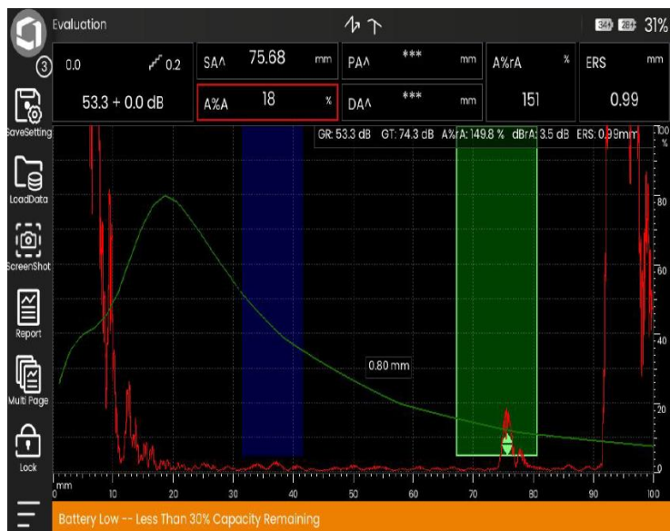
Slika 29. A-prikaz - USM 100 – MB5S – 2 0300
