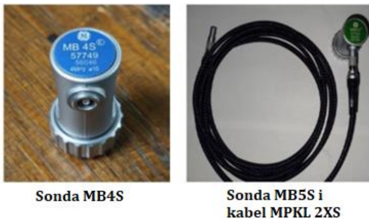
Slika 9. Ultrazvučne sonde korištene u provedbi mjerenja [9]
