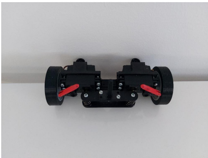
Slika 43. Izrađena stražnja osovina
