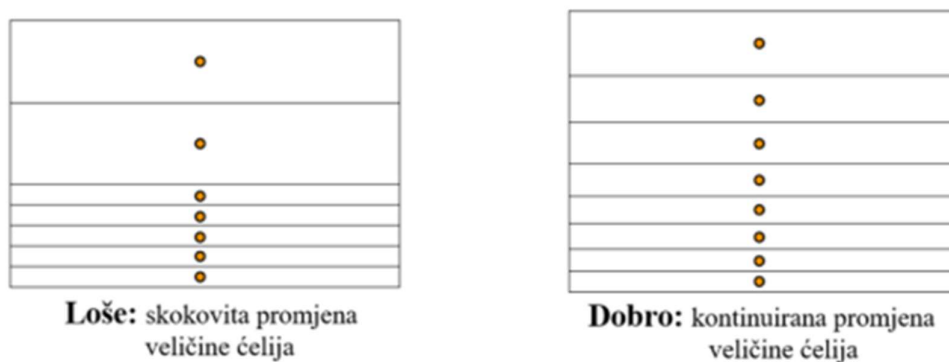
Slika 9. Dobra i loša diskretizacija graničnog sloja [27]
