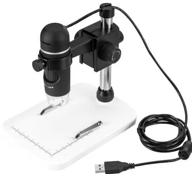
Slika 36. Svjetlosni mikroskop "Toolcraft DigiMicro Profi" [19].
