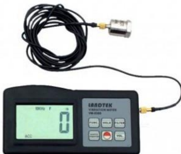
Slika 34. Uređaj za ispitivanje vibracija „VM-6360“ [17]
