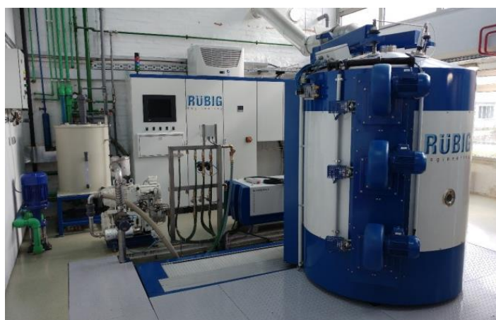
Slika 28. Vakuumska peć Rübiger PC 70/90 za nitiranje i PACVD prevlačenje
