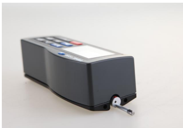
Slika 32. Uređaj za ispitivanje hrapavosti „TIME 3202“ [16]
