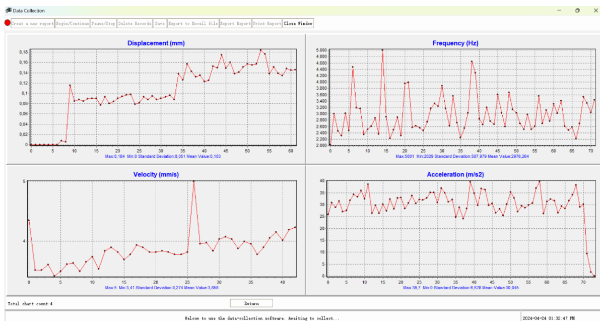
Slika 44. Grafički prikaz izmjerenih parametara vibracija
