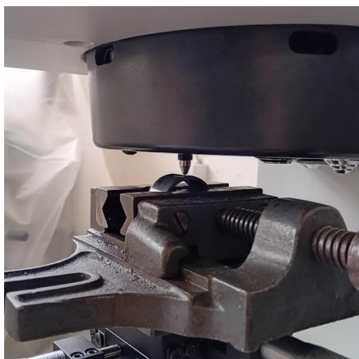
Slika 38. Mjerenje tvrdoće unutarnjeg prstena
