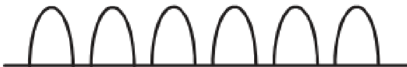
Slika 9 Prikaz izlazne istosmjerne struje ispravljača[4]
