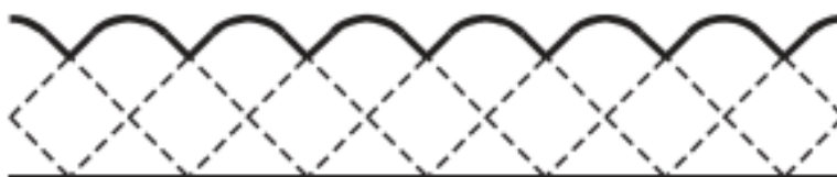
Slika 10 Prikaz izlaznog istosmjernog napona ispravljača[4]
