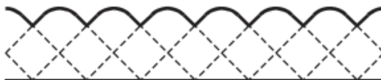
Slika 10 Prikaz izlaznog istosmjernog napona ispravljača[4]
