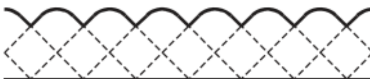
Slika 10 Prikaz izlaznog istosmjernog napona ispravljača[4]
