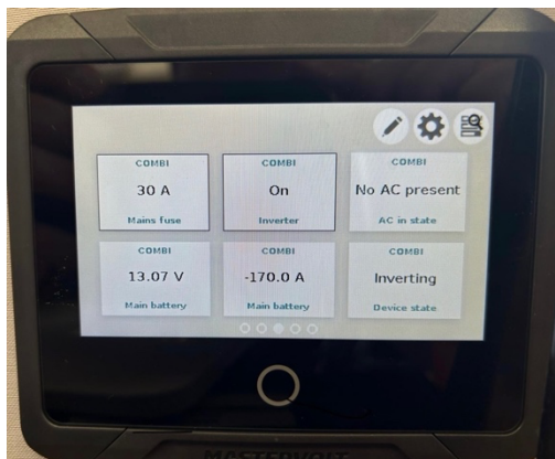
Slika 37. Potrošnja invertera pri radu klima uređaja u 4 kabine
