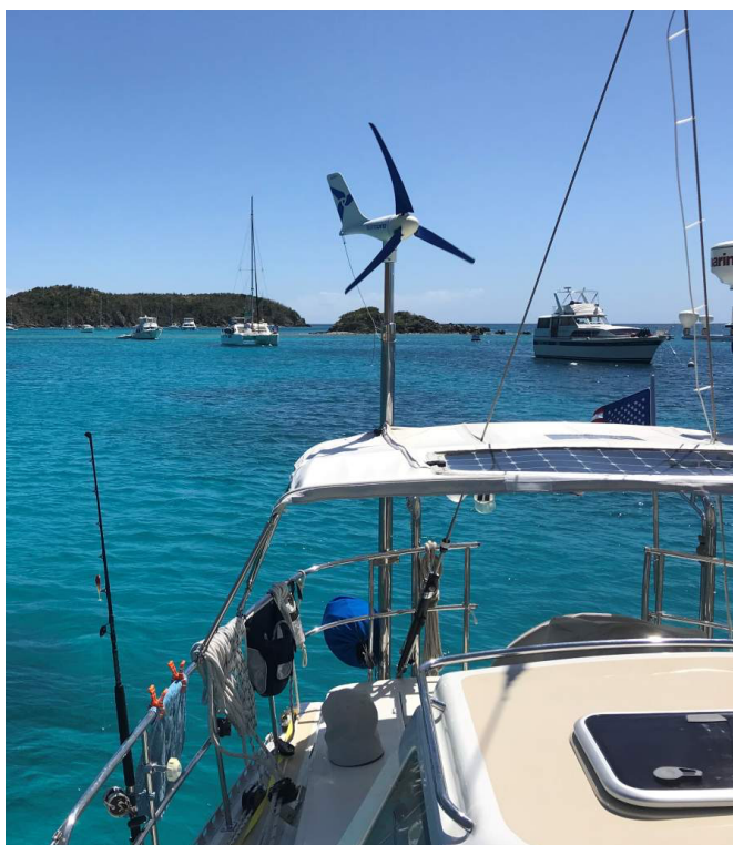
Slika 7. Montirana brodska vjetroturbina
